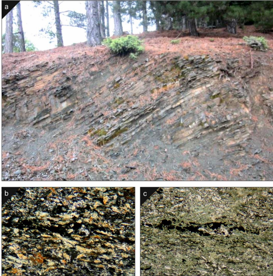
Şekil 4.2: İnceleme alanının temelini oluşturan Karakaya Kompleksi'ne ait metamorfiklerin mostra görünümü ve ince kesit görünümü. a) Şistozite düzlemleri belirgin metamorfikler, b-c) Baskın olarak kloritten ve daha az opak minerallerin görünümü ( N^+ , N^- ).
