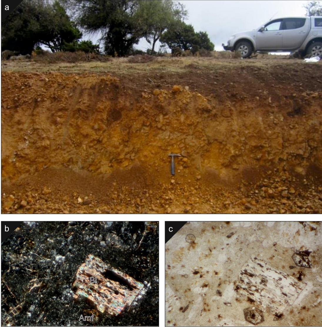
Şekil 4.5: Andezitik subvolkanik kayaçların görünümü. a) Andezit bileşimli subvolkanik kayaçların mostra görünümü, b-c) Playioklas bakımından zengin bir volkanik hamur ve serizitik laterasyona uğramış biyotit ve amfibol minerallerinden meydana gelen andezitin ince kesit görünümü (N + , N - ).
