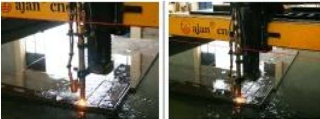
Şekil 3.16 Yarı römork imalatında kullanılan robotik uygulamalar
