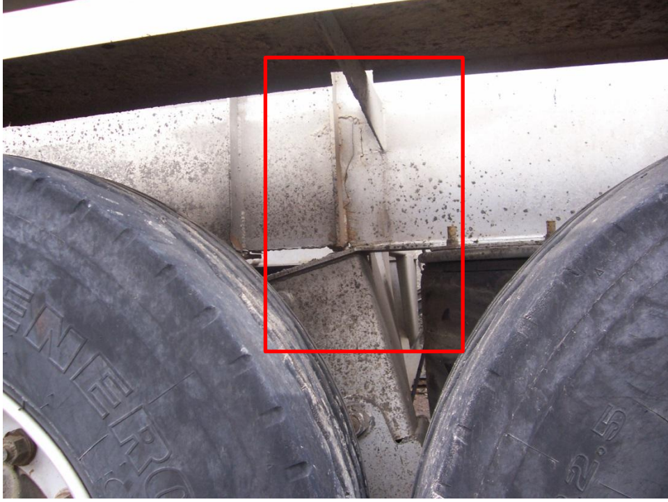
Şekil 3.25 Şasideki kaynak hataları
