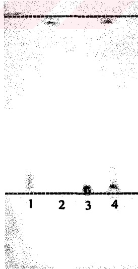
Şekil.3.53 FKDT-I tabakasında aseton ile yapılan mürekkep örneklerinin kromatogramı (1) mavi mürekkep (2) kırmızı mürekkep (3) siyah mürekkep (4) mürekkep karışımı.
