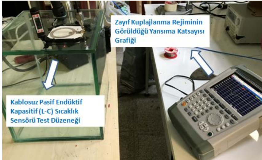
Şekil 4.12: Zayıf kuplajlanma rejiminde çalışan kablosuz pasif sensör test düzeneği.
