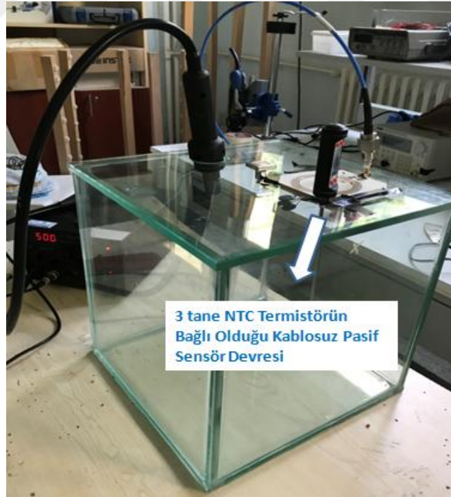
Şekil 4.13: Üç tane 43 \Omega NTC termistörlerin paralel bağlandığı test düzeneği.
