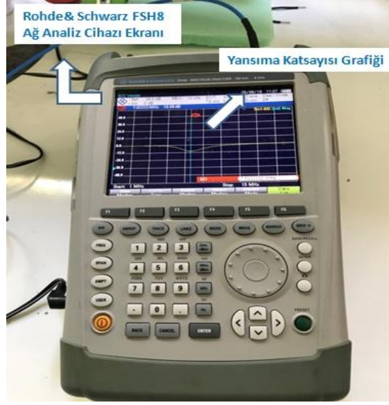
Şekil 4.9: Ağ analizör cihazı ekranından izlenebilen yansımaya katsayısı grafiği.
