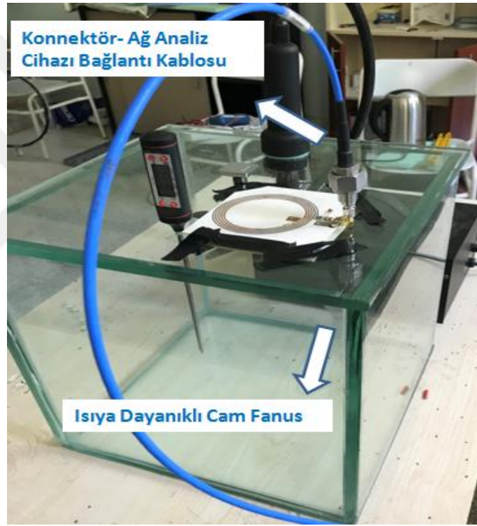
Şekil 4.4: Harici bobin devresi ile ağ analizör cihazı arasındaki bağlantı.
