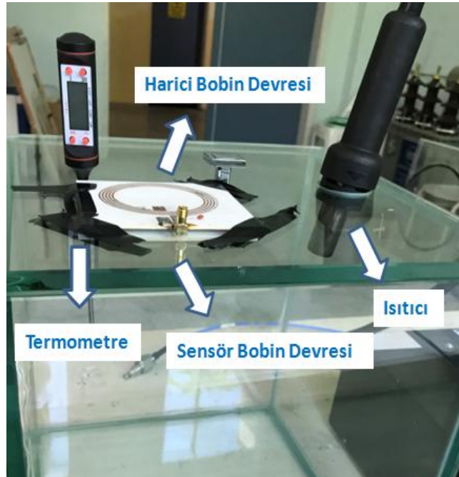
Şekil 4.3: Kablosuz pasif sıcaklık sensörü için deney düzeneği.
