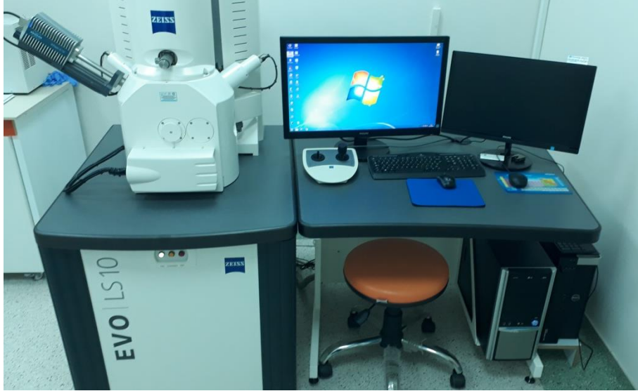
Şekil 2.14: ZEISS EVO LS 10 taramalı elektron mikroskobu.
