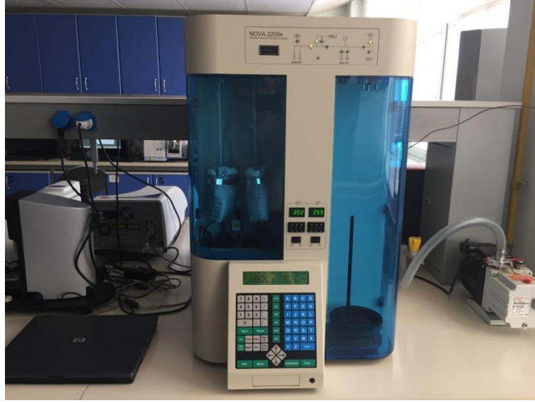
Şekil 2.15: NOVA 2200e (Quantachrome Instruments) BET yüzey alanı tayin cihazı.
