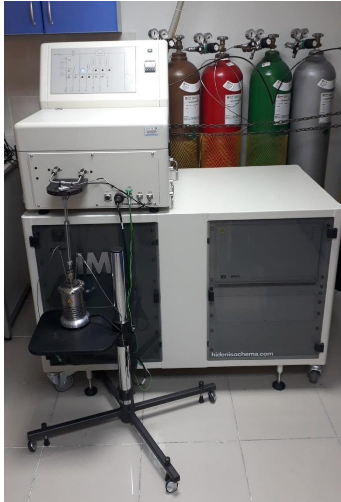
Şekil 2.16: IMI-HTP manometrik analiz cihazı.
