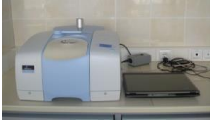
Şekil 2.11: Perkin Elmer Spektrum 100 FTIR-ATR spektrometresi.
