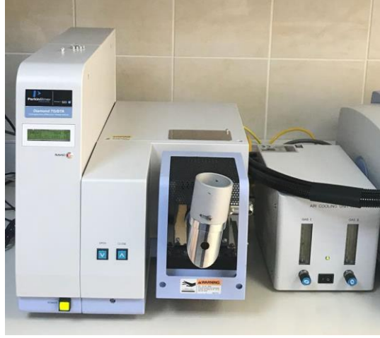
Şekil 2.12: Perkin Elmer Diamond Simultane DTA/TG cihazı.
