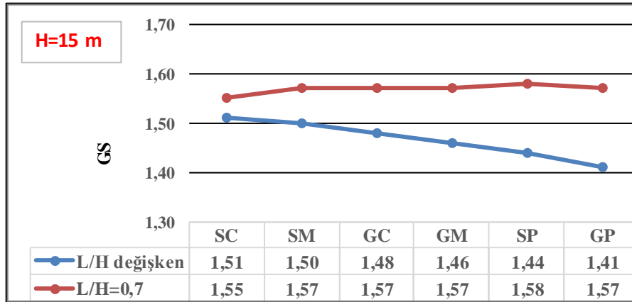
Şekil 4.20: H=15 m duvarda L/H oranlarına göre toptan göçme güvenlik sayılarının değişimi.
