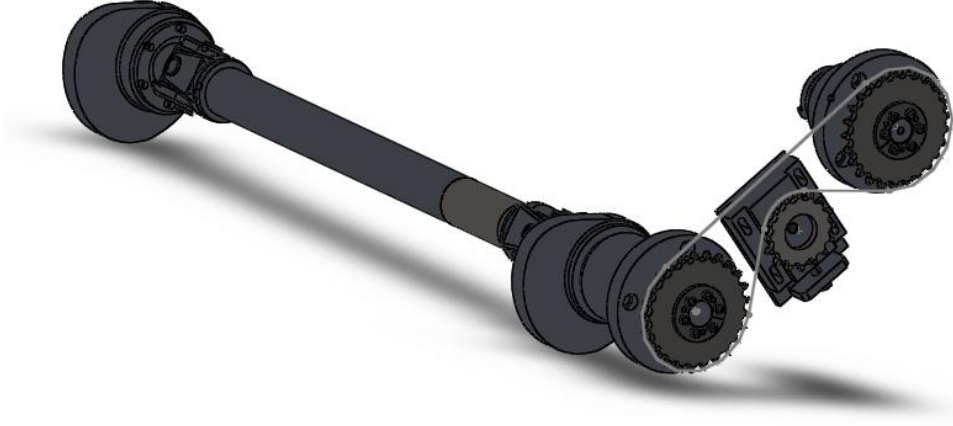
Şekil 5.106: Zincir dişli kutusundaki hareket aktarımı.
