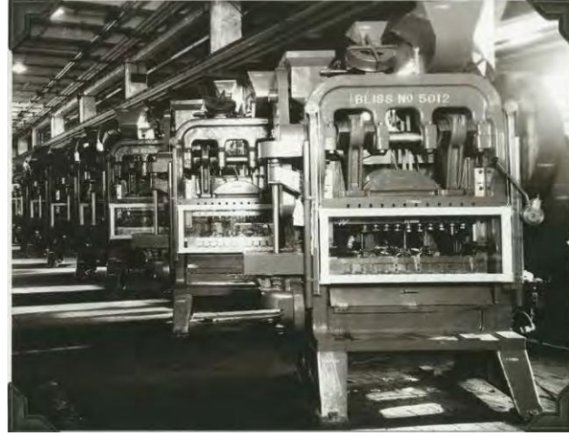
Şekil 3.4: The Bliss tarafından 1930 yılında imalatı gerçekleştirilmiş mermi çekirdeği üretim hattı [64].
