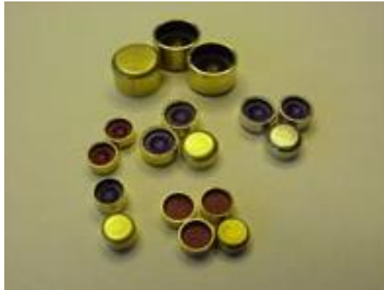
Şekil 4.12: Berdan tipi kapsül [77].
