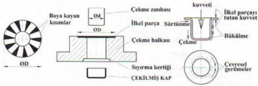
Şekil 5.166: Çekme esnasında meydana gelen gerilmeler [60].
