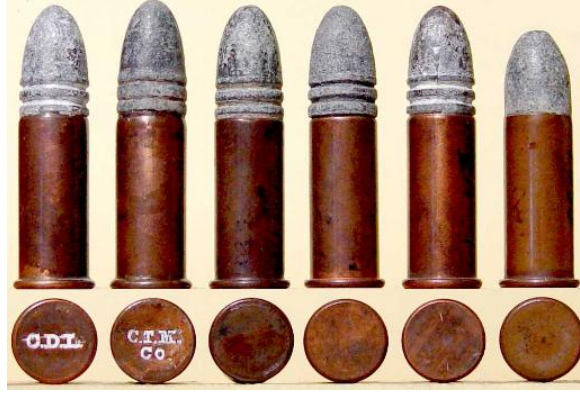
Şekil 1.20: 1800'lü yılların sonlarında üretilmiş çevresel vuruşlu fişekler [27].
