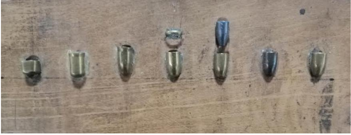
Şekil 5.163: 9x19 Mermi çekirdeği üretiminin işlem sırası.
