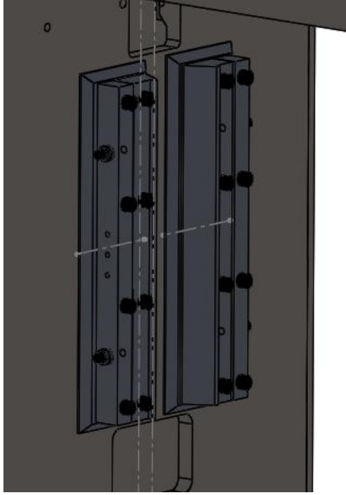
Şekil 5.83: Üst zımba tutucu bloğun doğrusal hareket etmesini sağlayan kızaklar.
