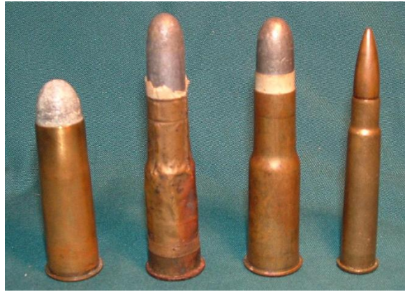
Şekil 1.21: 1800'lü yılların sonlarına doğru üretilen merkez ateşlemeli fişekler [28].
