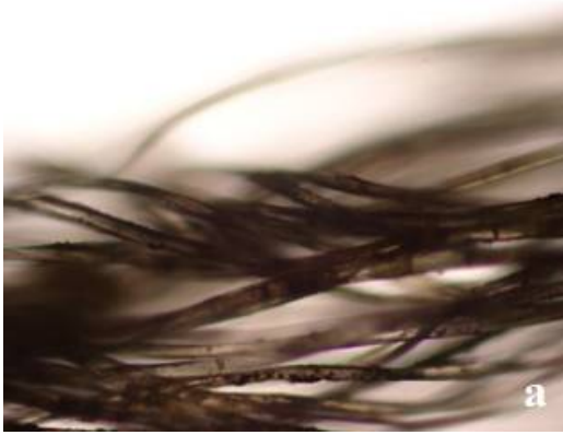
Şekil 3.24: a) PETY1Ç4 kodlu çalışmaya ait lifin ışık mikroskobu ile x200 büyütülmüş görüntüsü. b) PETY1Ç5 kodlu çalışmaya ait lifin ışık mikroskobu ile x200 büyütülmüş görüntüsü.
