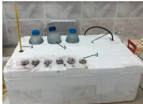
Şekil 3.1: Polimerizasyon sistemi a) termometre b) buz c) sirkülatör d) polimerizasyon kabı.
