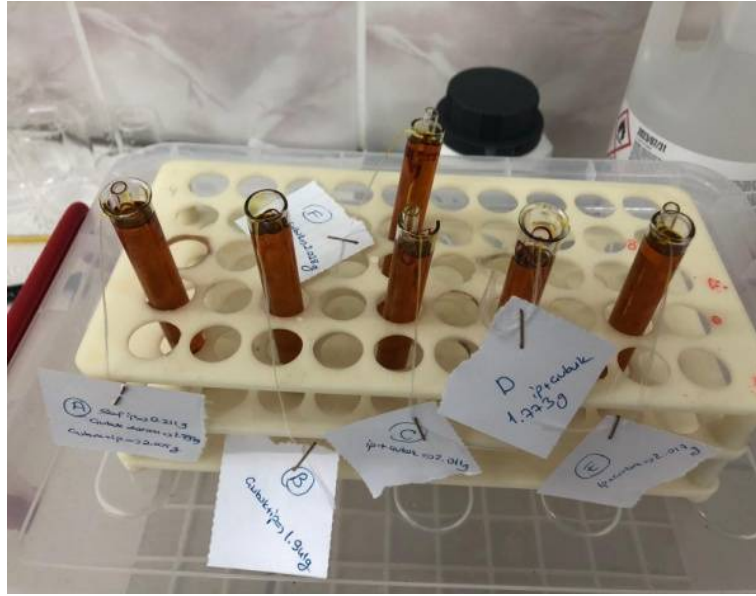
Şekil 3.12: İnce cam çubuklara sarılarak içerisinde 2.0 M Fe +3 çözeltisi bulunan deney tüplerine yerleştirilen PP lifler.
