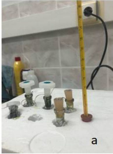
Şekil 3.8: a) Balon jodeye yerleştirilen PP lif b) Deney tüpüne yerleştirilen PP lif.
