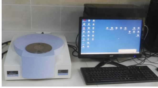
Şekil 3.6: Perkin elmer diamond DSC 4000 cihazı.
