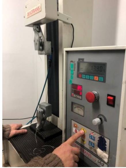
Şekil 3.4: Çekme Test Cihazı.
