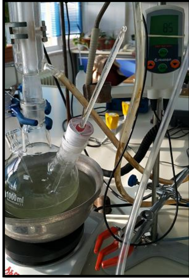
Fotoğraf 4.6: Çaprazbağlı poliakrilamid sentez aşaması.
