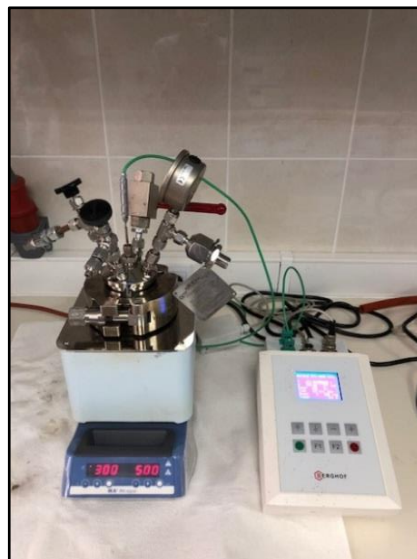
Şekil 2.2: Hidrotermal karbonizasyon yönteminde kullanılan otoklav sistemi.
