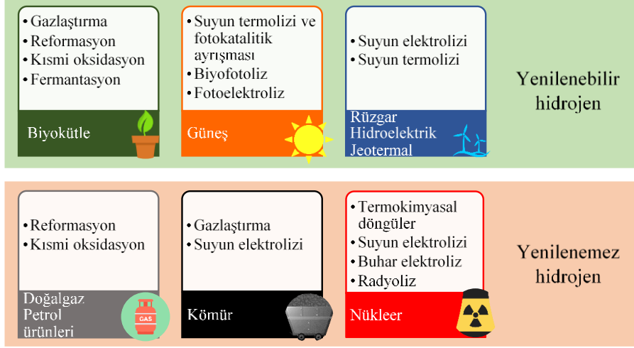
Şekil 1.1: Hidrojen üretim kaynakları ve yöntemleri.
