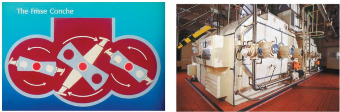
Şekil 4. Günümüzde Kullanılan Konç Makinası ve Çalışma Prensibi
