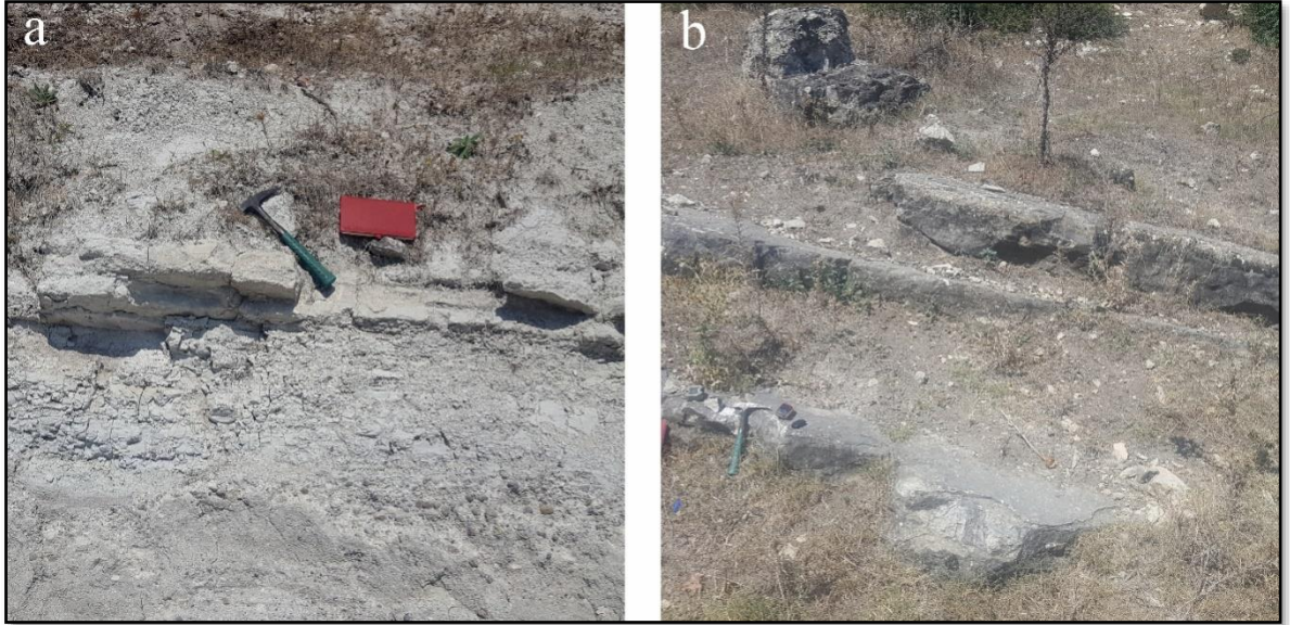
Şekil 3.10: Soma formasyonuna ait arazi fotoğrafları; a) Beyaz renkli kumlu kireçtaşı, kumtaşı ar dalanması b) Kozören-Karakavak mahalleleri geçiş yolu beyazımsı tabakalı ve 346/48 eğim doğrultulu kireçtaşı-kumtaşı ar dalanması.
