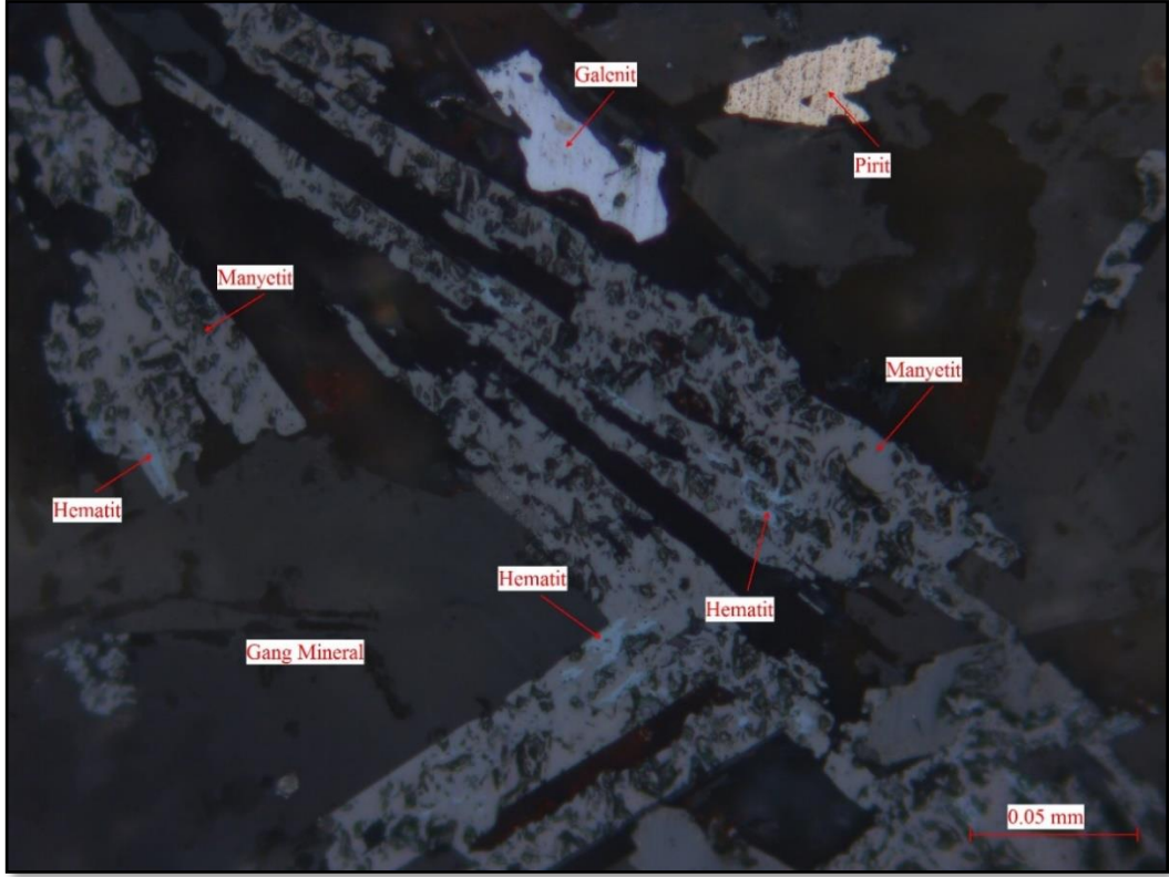
Şekil 3.36: K5 örneğindeki hematit minerallerinin demetler şeklinde mikroskop görüntüsü
