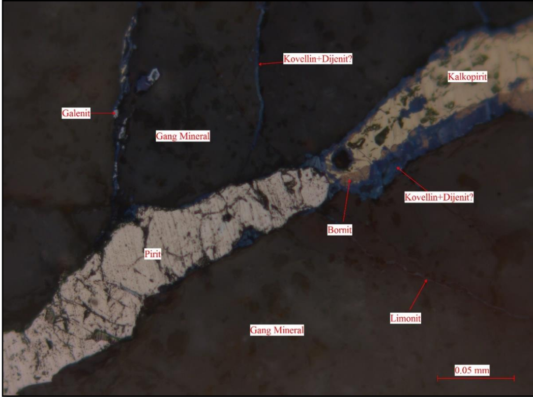
Şekil 3.42: K4 örneğindeki pirit mineralinin gang mineralleri arasındaki mikroskop görüntüsü
