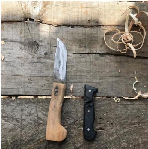
Şekil 4.45.3: Juglans regia kullanılarak yapılmış bıçak sapı
