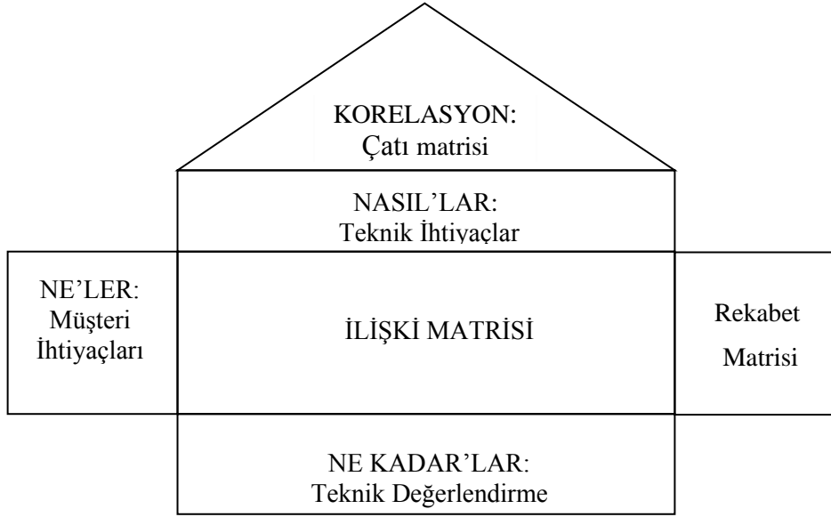
Şekil 1. Kalite evinin temel yapısı.
