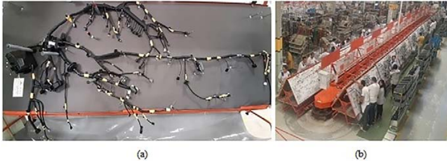
Şekil 1. Kablo demeti ve kablo demetleme konveyör hattı (Wiring harness and wiring harness conveyor line)
