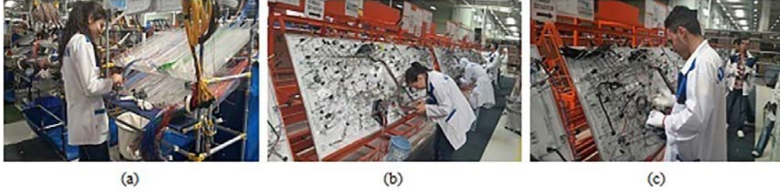
Şekil 2. Kablo demetleme konveyör hattındaki işlemler (Operations on the wiring harness conveyor line) a) Ön hazırlık (Preliminary preparation) b) Kablo döşeme (Cable laying and taping) c) Bantlama ve aksesuar takma (Banding and accessory insertion)
