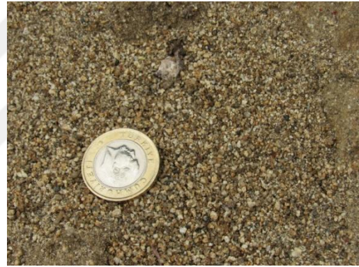
Fotoğraf 24. Granit Anakayasının Biyokimyasal Ve Mekanik Alterasyonu Sonucu Oluşmuş Arena.
