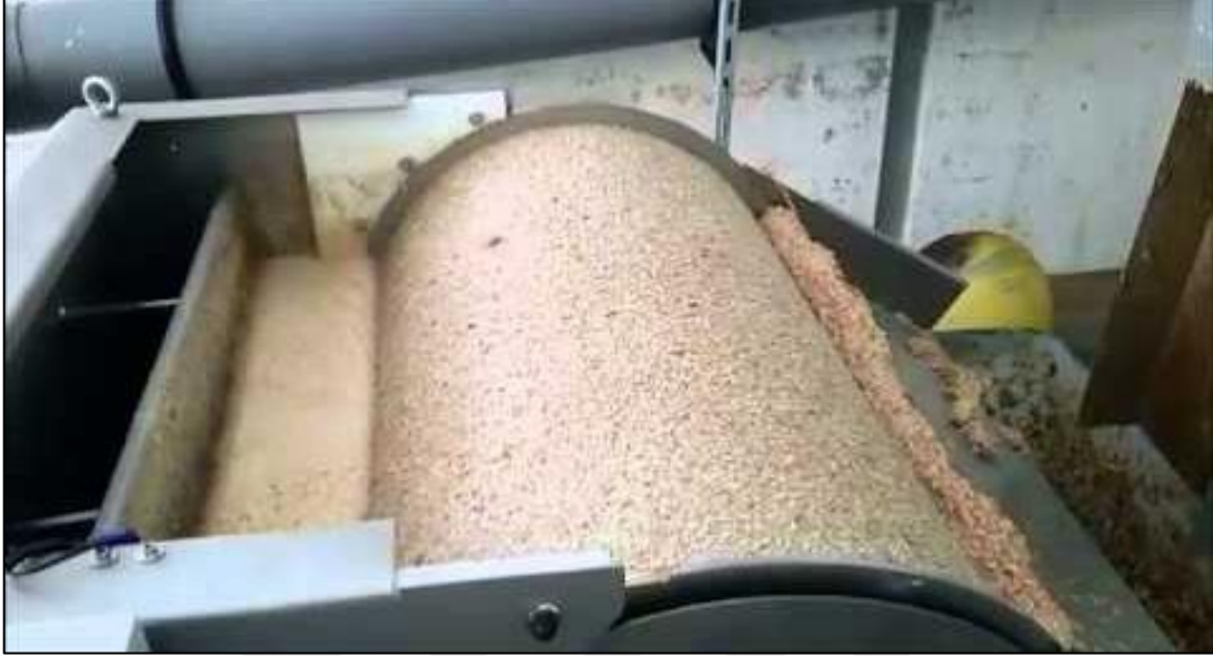
Şekil 2.1: Tambur elek kullanılarak mezbaha atıksularının ön arıtımı [13]
