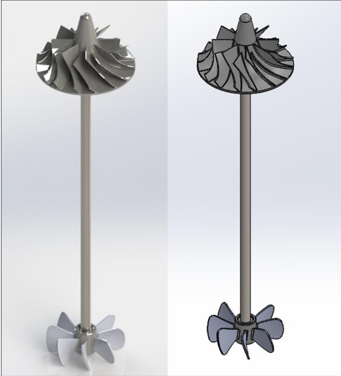
Şekil 4.12: Jet loop reaktörün çarpma plakası olarak kullanılan ve anaerobik bölgeyi karıştıran pervane ve milin üç boyutlu tasarım programındaki montajı.
