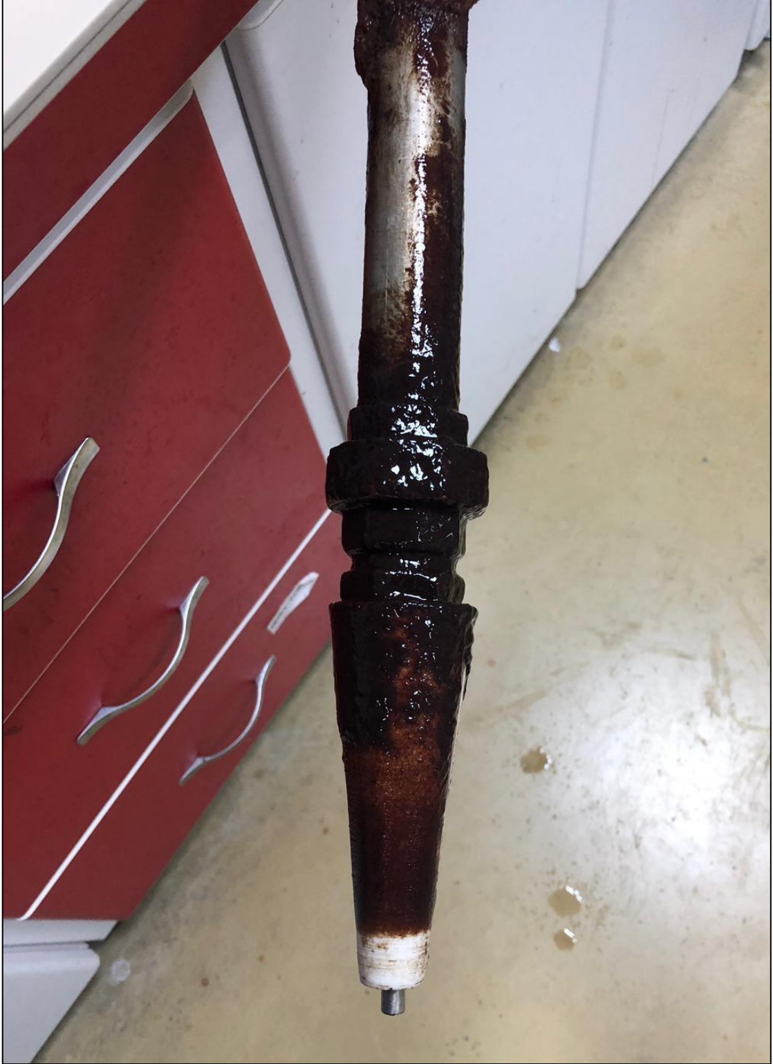
Şekil 4.44: Membran Draft Tüplü Jet Loop Reaktör'ün (MDJLR) jet nozzle kısmında meydana gelen biyofilm tabakası
