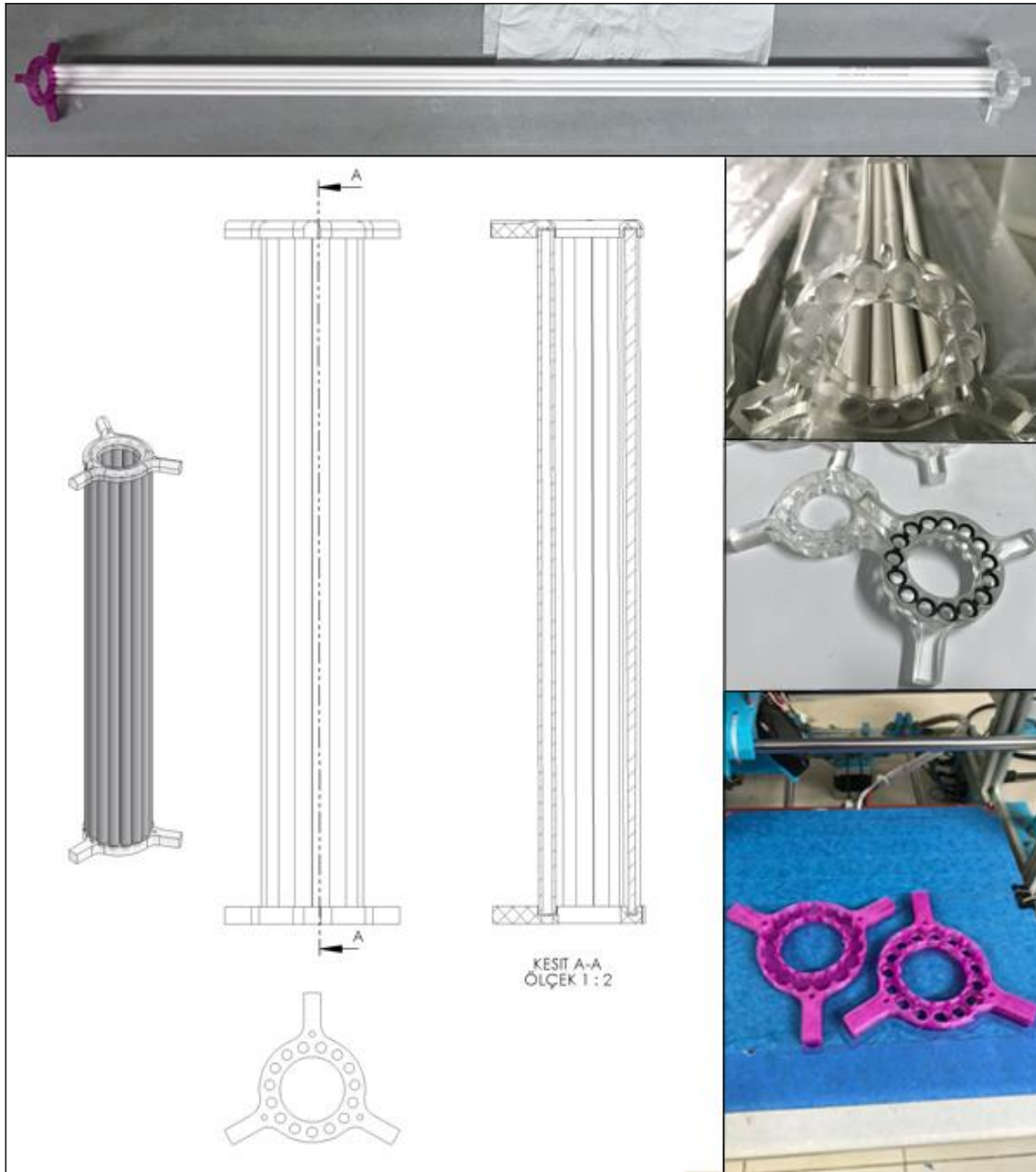
Şekil 4.6: Seramik membranlar, seramik membranlara ait birleştirme ve montaj aparatları, birleştirme ve montaj aparatlarının üç boyutlu yazıcı ile prototiplenmesi
