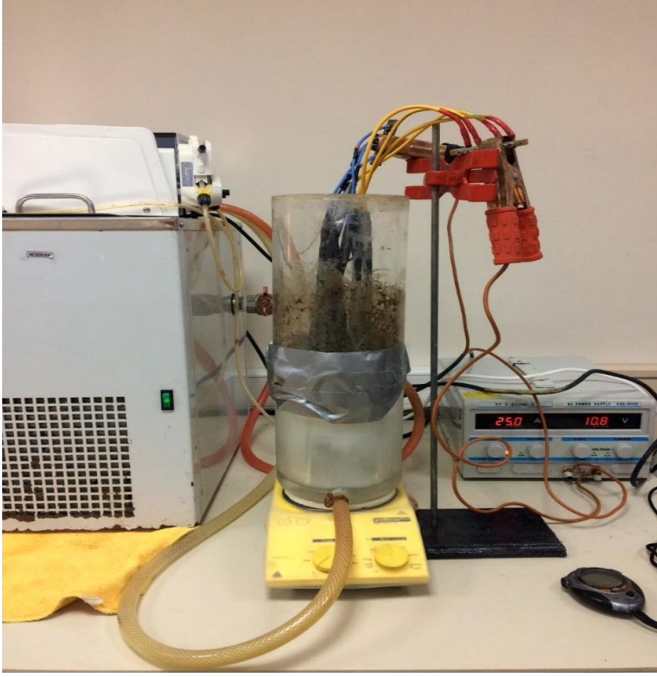
Şekil 3.3: 10,12 mA/cm 2 akımda deneyin ilk 10 dakikasında atıksuyun görüntüsü
