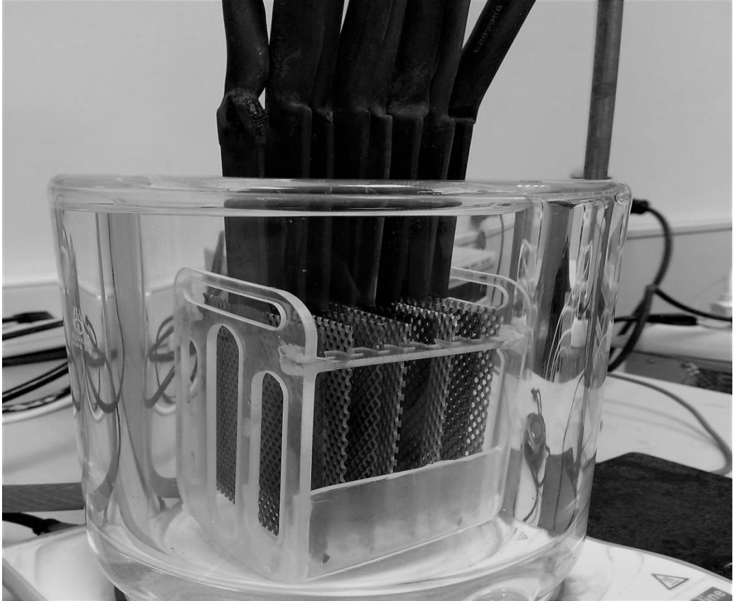
Şekil 3.1: Denemelerde kullanılan anot katot düzeneği dizilimi
