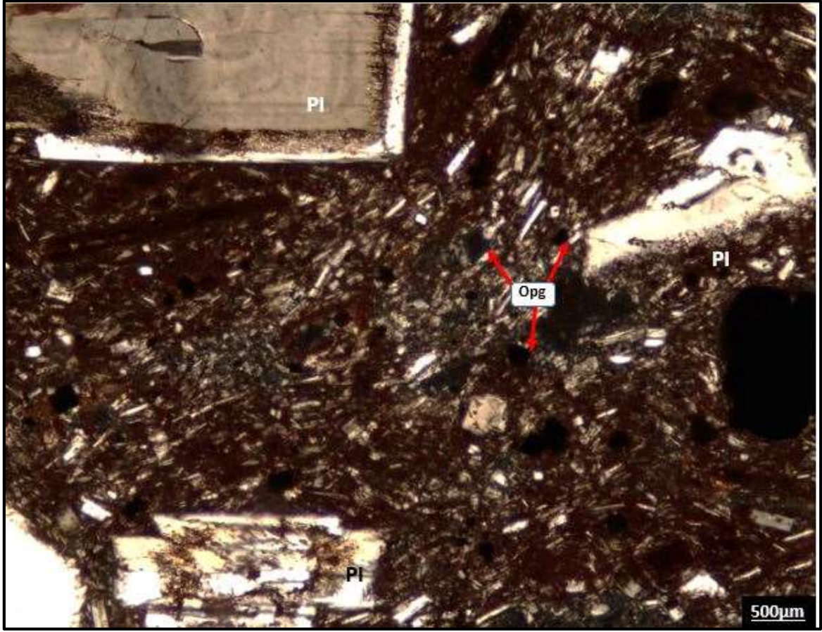
Şekil 4.9: Akma yapısı gösteren plajiyoklaz mikrolitlerinin ince kesit görünümü (Ç.N.; Pl: Plajiyoklaz, Opg: Opak Mineral).
