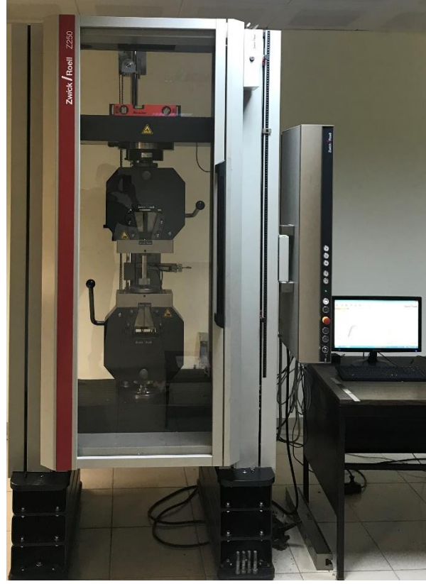
Şekil 5.14: Çalışmada kullanılan universal basma test cihazı.
