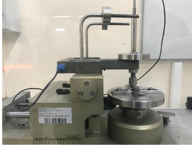
Şekil 5.12: Çalışmada kullanılan univarsal aşınma test cihazı.
