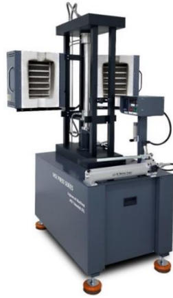
Şekil 5.4: Çalışmada kullanılan sıcak pres cihazı.
