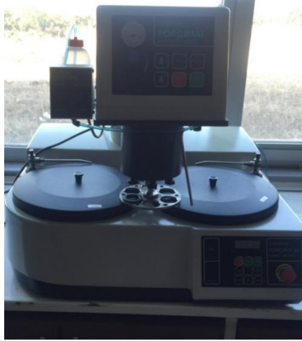
Şekil 5.5: Zımparalama ve parlatma işleminin yapıldığı cihaz.
