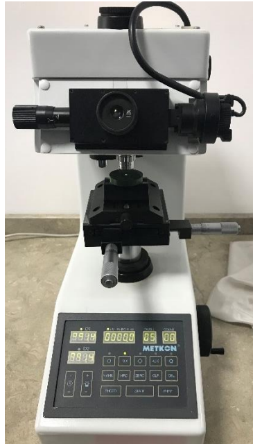
Şekil 5.13: Sertliklerin testlerinin gerçekleştirildiği mikro sertlik cihazı.
