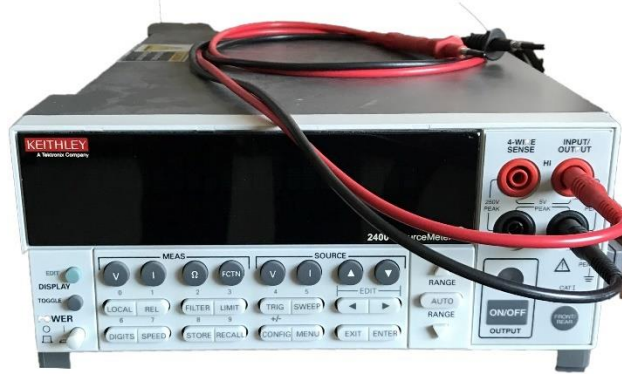
Şekil 5.11: Çalışmada elektriksel iletkenlik ölçümlerinde kullanılan cihaz.
