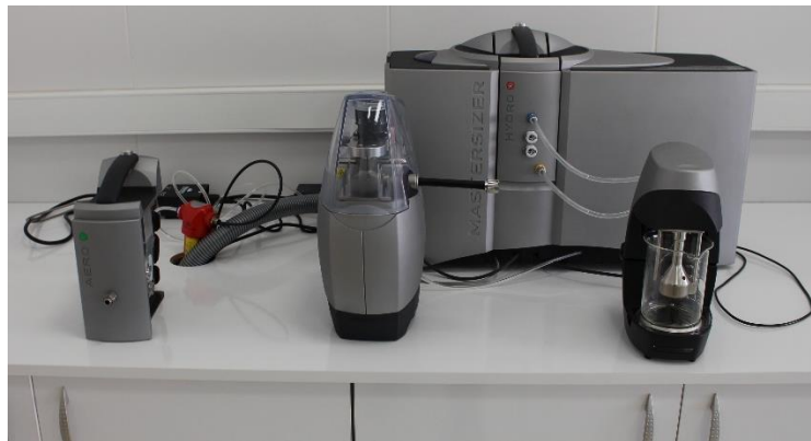
Şekil 5.7: Çalışmada kullanılan parçacık boyut analiz cihazı.
