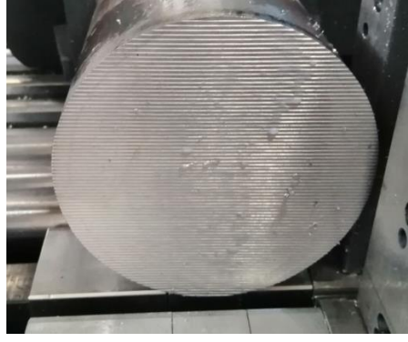
Şekil 4.13: 2.Deneyde İlerleme hızı 37 mm/dak ve kesme hızı 60 m/dak kullanırken ortaya çıkan yüzey
