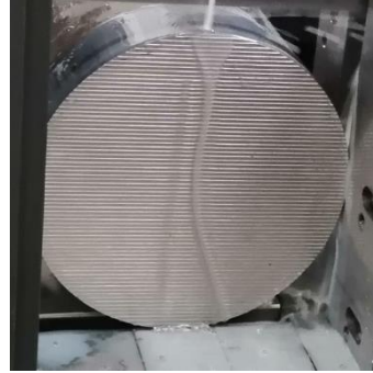
Şekil 4.10: 2.Deneyde ilerleme hızı 30 mm/dak ve kesme hızı 60 m/dak değerlerinde olduğunda ortaya çıkan yüzey
