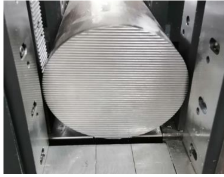
Şekil 4.12: 2.Deneyde ilerleme hızı 30 mm/dak ve kesme hızı 76 m/dak değerinde olduğunda ortaya çıkan yüzey
