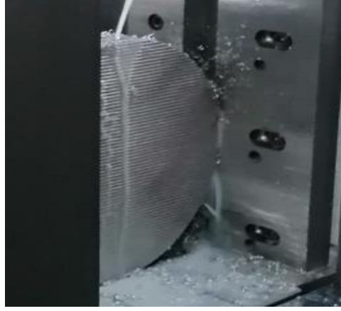
Şekil 4.11: 2.Deneyde ilerleme hızı 30 mm/dak ve kesme hızı 68 m/dak değerinde olduğunda ortaya çıkan yüzey
