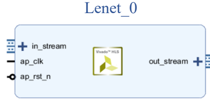
Şekil 5.7: Lenet-5 modeli IP bloğu.
