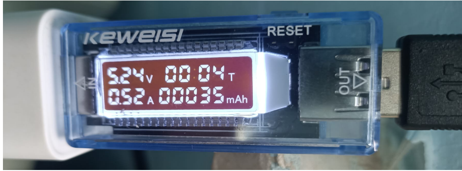
Şekil 5.23: Fiziksel ölçümlerde kullanılan USB güç ölçer.
