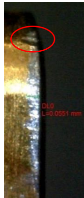
Şekil 5.10 : Gözlenen çentik aşınması.
