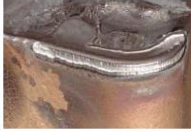
Şekil 2.13 : Serbest yüzey aşınması [12].
