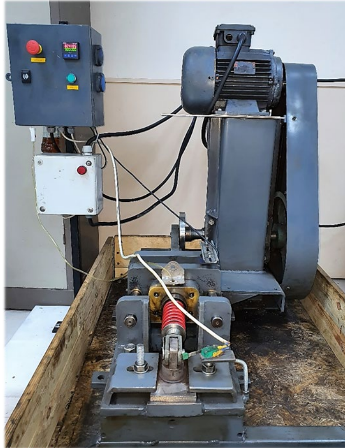
Şekil 4.17: Yapıştırma bağı için geliştirilen yorulma test cihazı.
