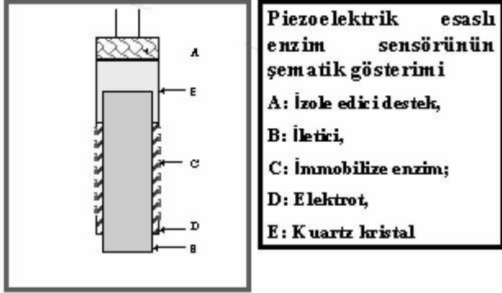
Şekil 5.4: Piezoelektrik esaslı enzim sensörünün şematik gösterimi [54].
