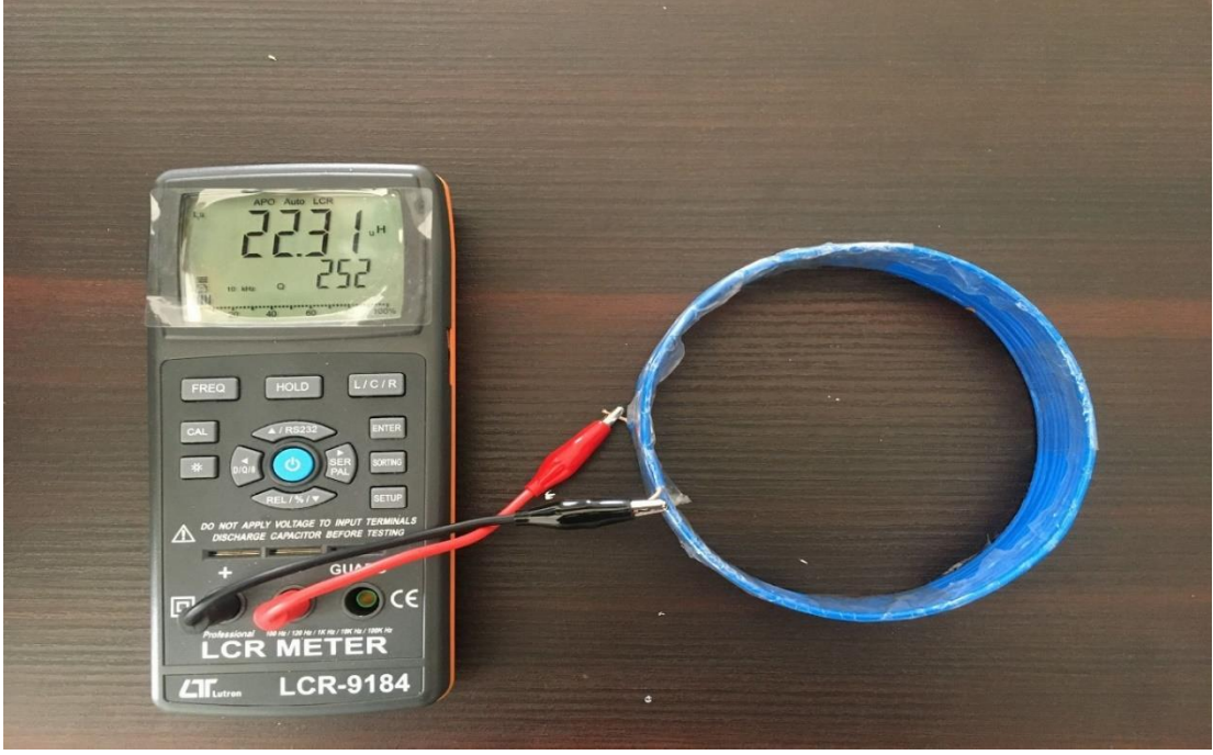
Şekil 3.6: Endüktans ölçümü düzeneği.
