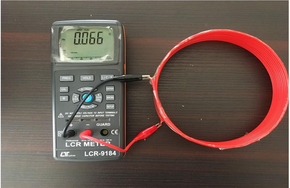
Şekil 3.10: Kapasite ölçüm düzeneği.
