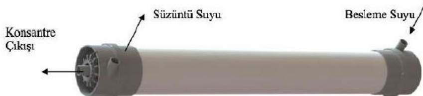
Şekil 2.11: Çapraz akışla çalışan bir içi boşluklu fiber membran modülü [9].
