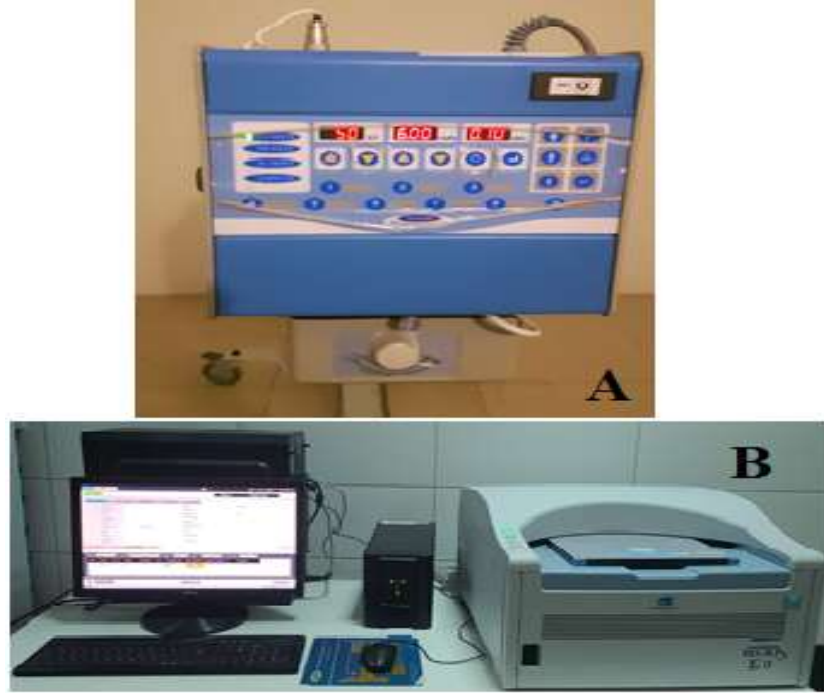
Şekil 3.2. Radyolojik muayene için kullanılan A) röntgen cihazı ve B) bilgisayarlı röntgen sistemi.
