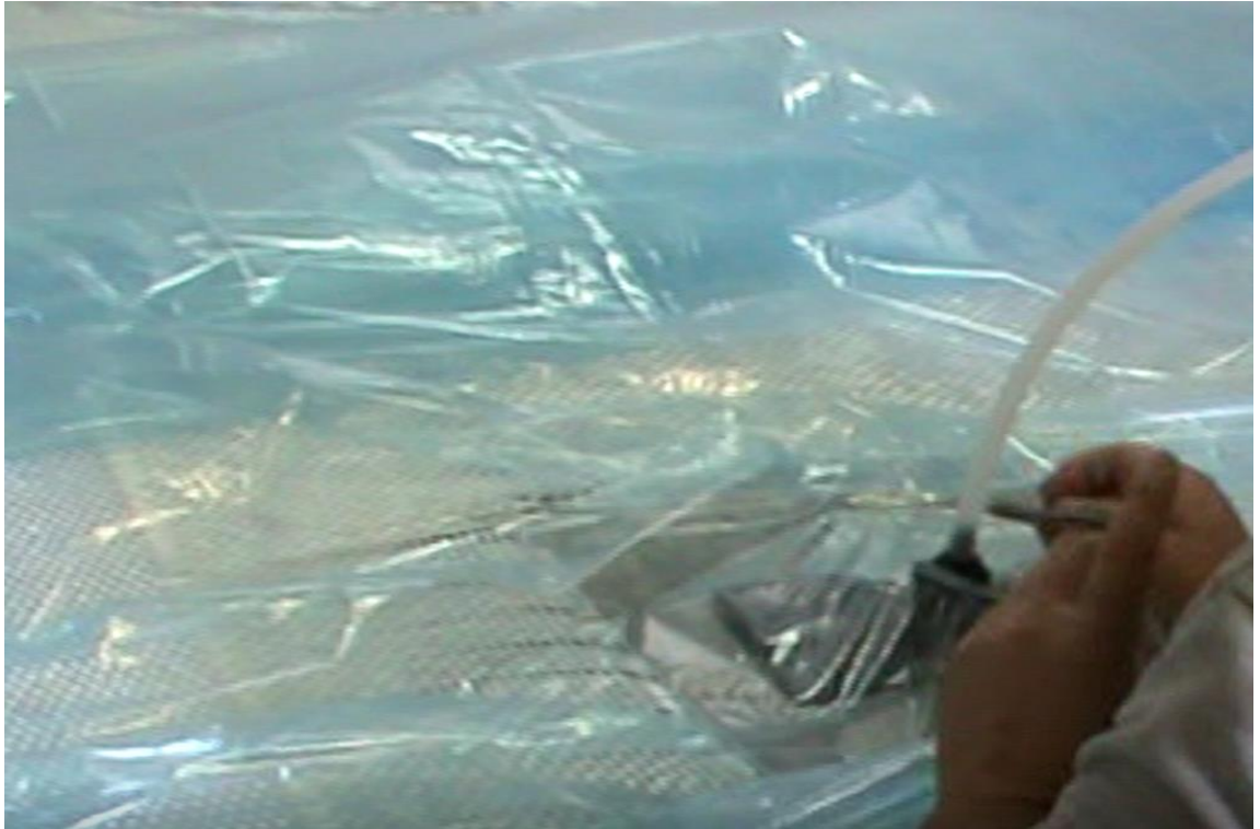
Şekil 1.24: Hava emiş supaplarına hortumların takılma süreci.
