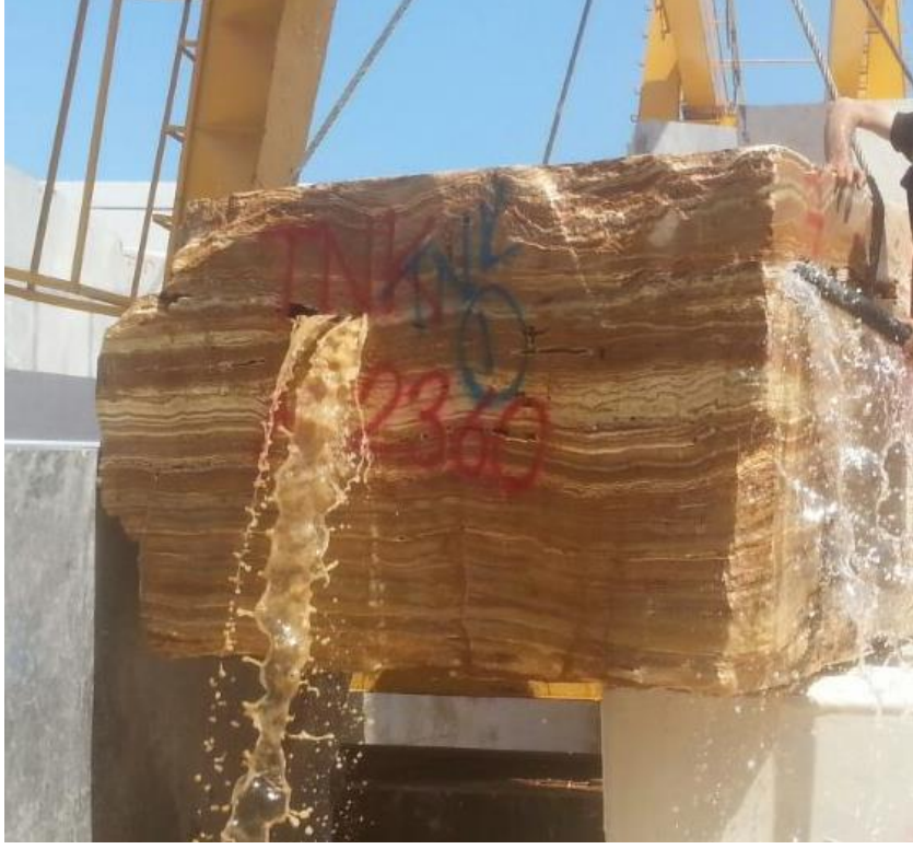
Şekil 1.5: Yıkaması yapılan blok örneği (Url 1).
