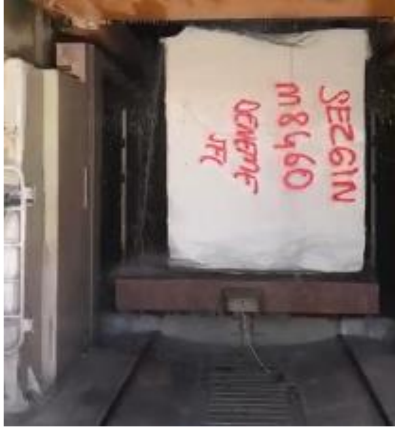
Şekil 3.8: Katrakta kesimi yapılan blok.
