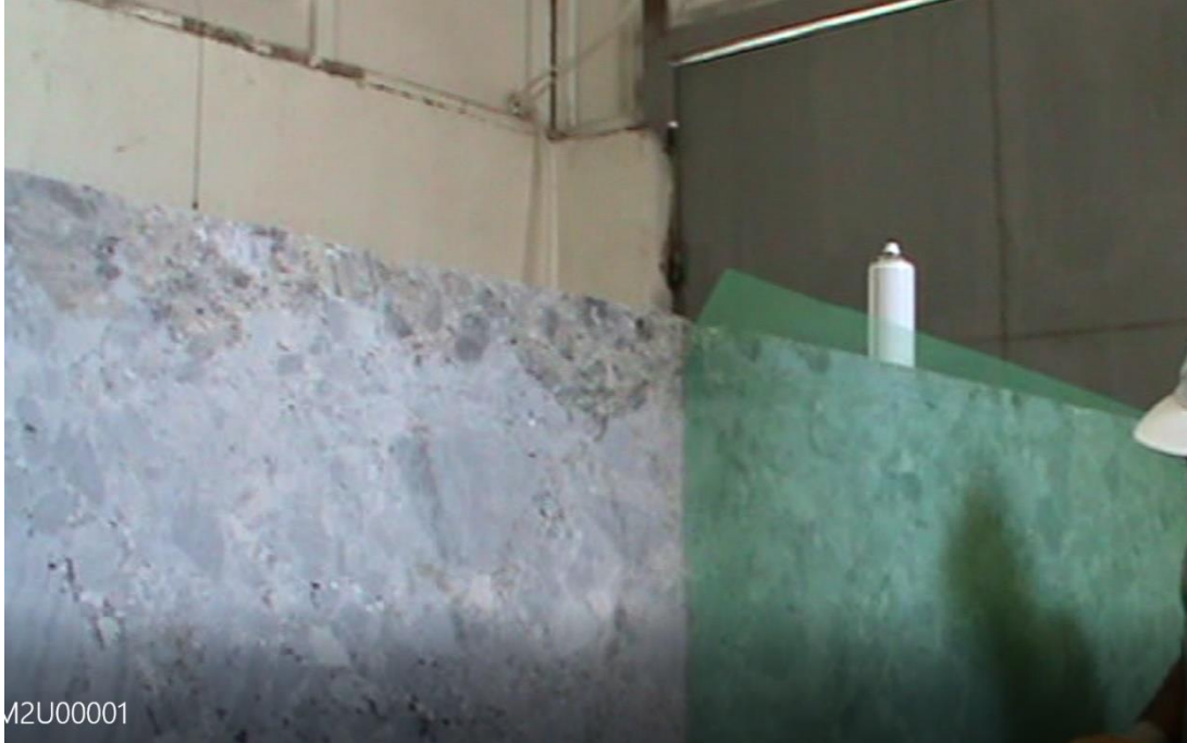
řekil 1.13: Blođa yayılma filesi uygulama ařaması.
