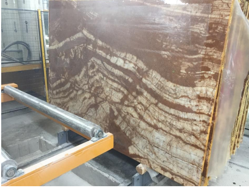
Şekil 1.42: Arka yüzeyi epoksi ve file uygulaması yapılmış kuruma işlemi tamamlanmış levha örneği.
