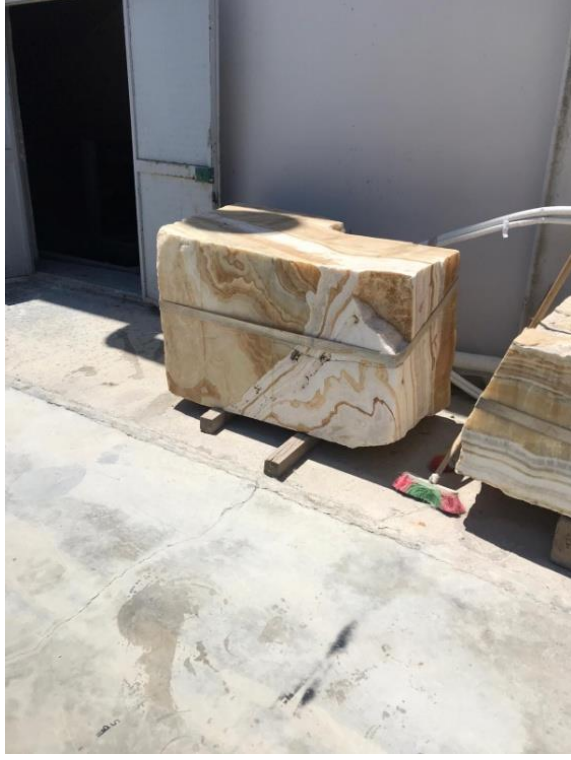
Şekil 3.2: Çatlaklı blok mermer örneđi.
