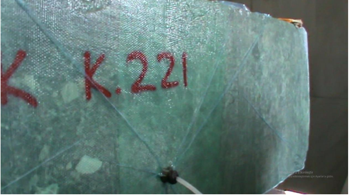
Şekil 1.32: Bloğun tamamının epoksi ile kaplanmış hali.
