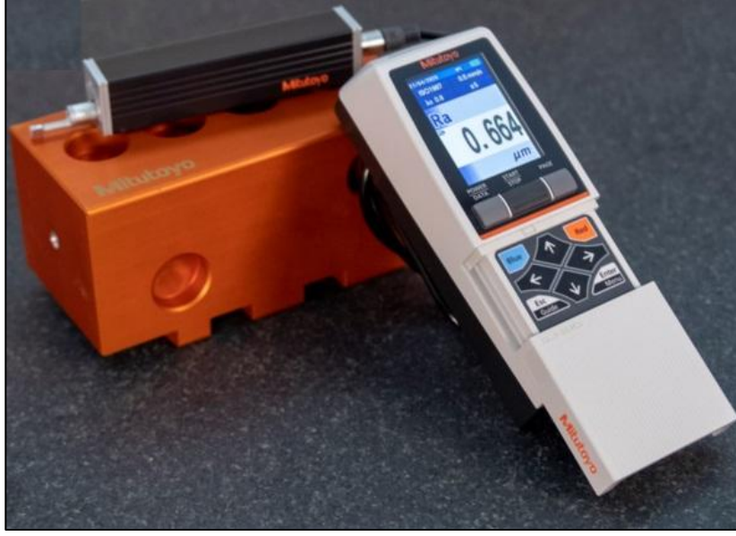
Şekil 4.4: Yüzey pürüzlülüğü ölçüm cihazı.
