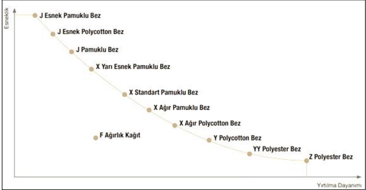
Şekil 3.14: Kağıt ve bez mesnetlerde yırtılma dayanımı ve esneklik grafiği.
