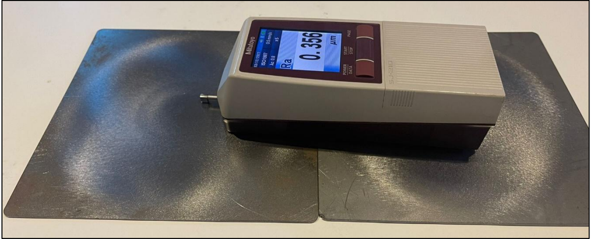
Şekil 4.5: Yüzey pürüzlülüğünün ölçüm şekli.
