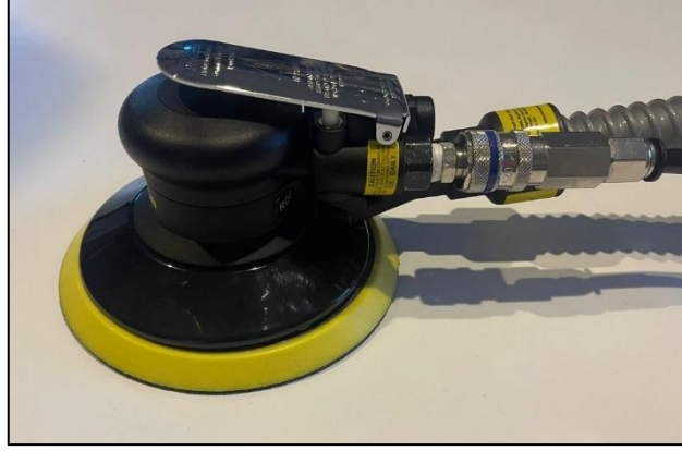
Şekil 4.2: Kb Promach ROS6316CV havalı zımpara makinesi.
