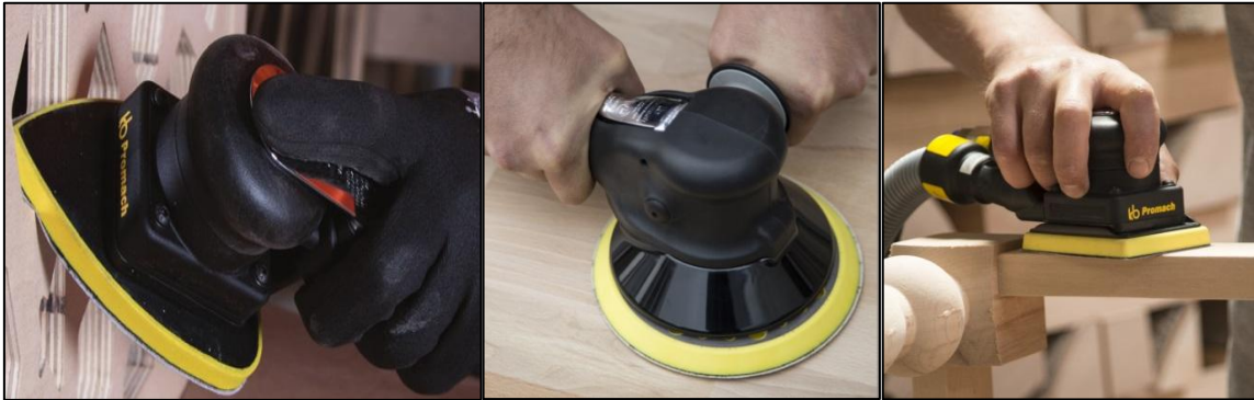
Şekil 3.18: Farklı şekillerde havalı zımpara makineleri.
