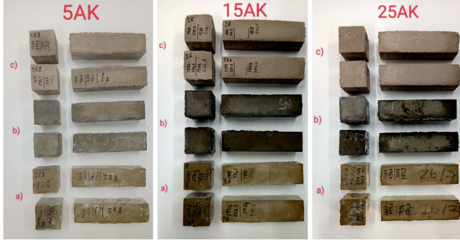
Şekil 4.10: 5KA, 15AK, 25AK, a) 300°C b) 600°C c) 900°C
