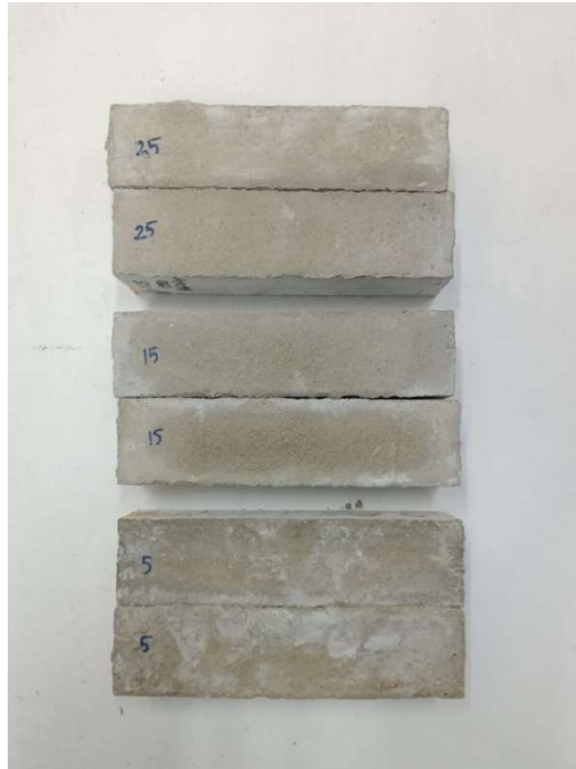
Şekil 4.15: Donma çözülme etkisi 5AK, 15AK, 25AK
