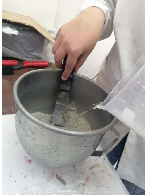
Şekil 3.7: Bağlayıcı ve alkali aktivatörün birleştirilmesi
