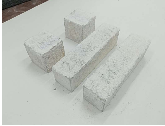
Şekil 4.27: 2 ay sodyum sülfat etkisi ile 25AK serisinde oluşan çiçeklenme
