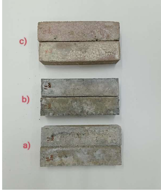
Şekil 4.8: KS serisi yüksek sıcaklık etkisi a) 300°C b) 600°C c) 900°C
