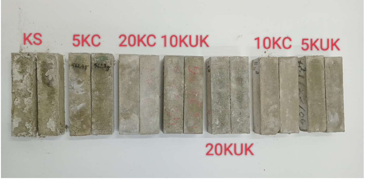
Şekil 4.16: Donma çözülme etkisi KS, 5KC, 20KC, 10KUK, 20KUK, 10KC, 5KUK
