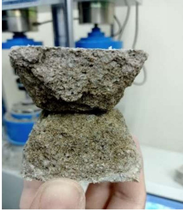
Şekil 4.17: Donma çözülme deneyinden sonra kolemanit atığı içeren serilerde görülen gevrek kırılma
