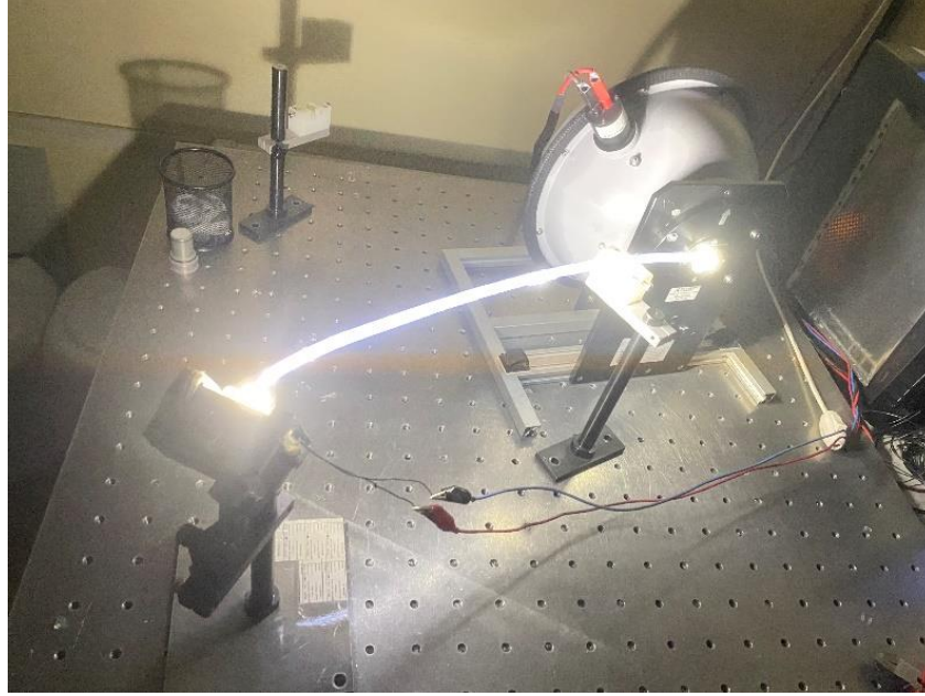
Şekil 4.7: Optik küre ölçüm cihazı ile ölçüm anı.
