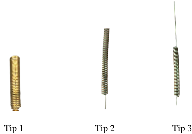
Şekil 3.12: Üretilen elektriksel küçük monopol anten modelleri.
