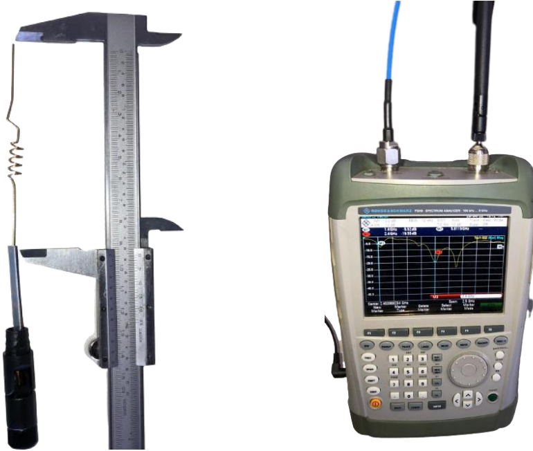
Şekil 4.3: Test ortamı ve ölçümlerin gerçekleştirilmesi (Üretilen anten ölçümü).
