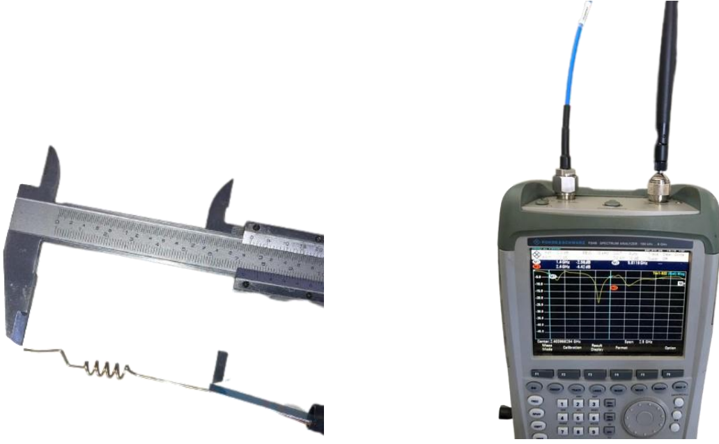
Şekil 4.4: Test ortamı ve ölçümlerin gerçekleştirilmesi (2 cm kesilen anten ölçümü).
