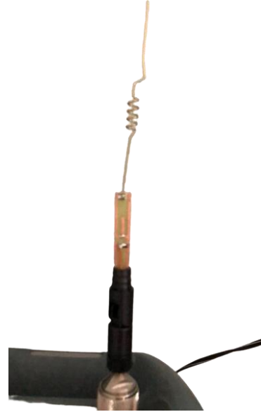
Şekil 3.42: Üretilen yüksek kazançlı Monopol 2.4 GHz minyatürize antenin VNA ölçüm görüntüsü.
