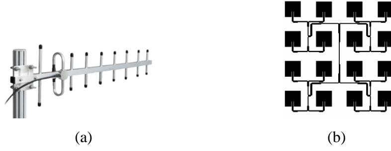
Şekil 1.7: Dizi anten örnekleri a) Yagi-Uda dizi b) Mikroşerit yama dizi.
