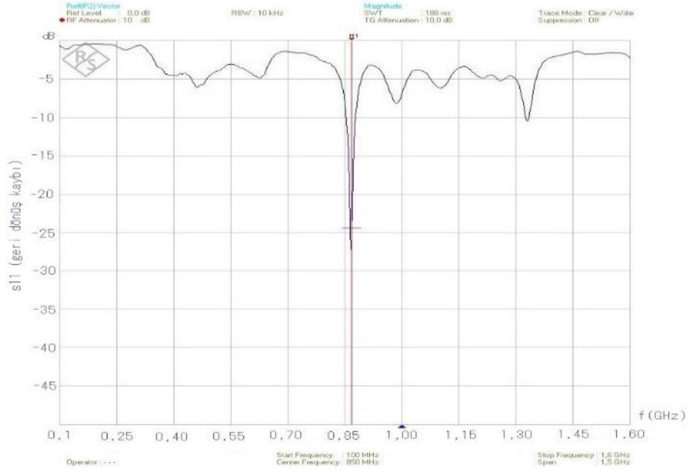
Şekil 5.5: Üretilen doğrudan dizi anten ölçüm sonucu (S11).
