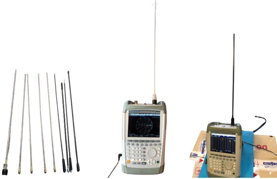
Şekil 3.4: Üretilen çeyrek dalga monopol anten modelleri.
