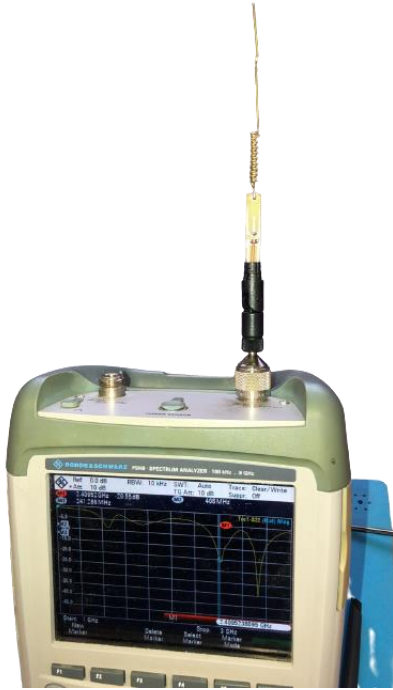
Şekil 3.42: Üretilen yüksek kazançlı Monopol 2.4 GHz minyatürize antenin VNA ölçüm görüntüsü.
