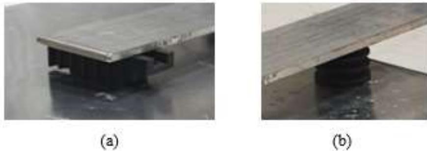
Şekil 7.2: Deneyde kullanılan takoz örnekleri (a) Leplast takoz, (b) Silindirik takoz.
