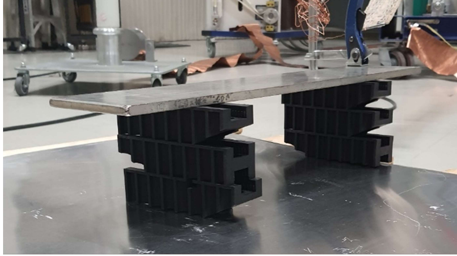
Şekil 7.9: Üç leplast takoz ile yapılan deney düzeneği.
