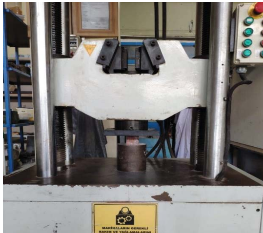
Şekil 3.4: Basınç dayanımı uygulaması
