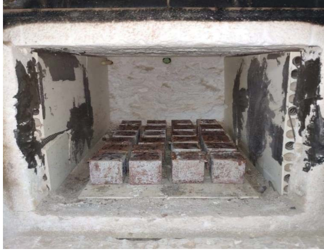
Şekil 3.9: Kül fırınına yerleştirilen numuneler
