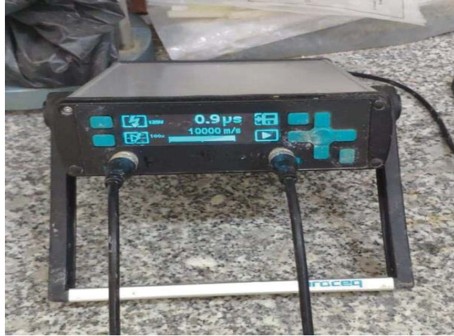
řekil 3.8: Ultrases geçiř hızı testinde kullanılan cihaz
