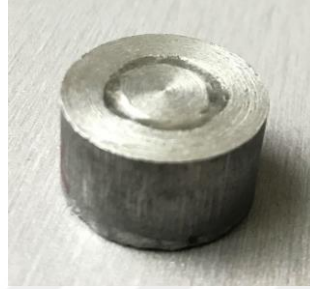
Şekil 4.1: Ø 20 mm olacak şekilde preslenerek aşınma testi uygulanmış numune örneği.
