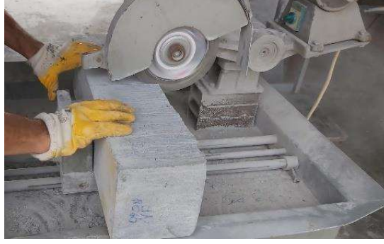
Şekil 2.7: Prizmatik kirişlere çentik uygulaması.
