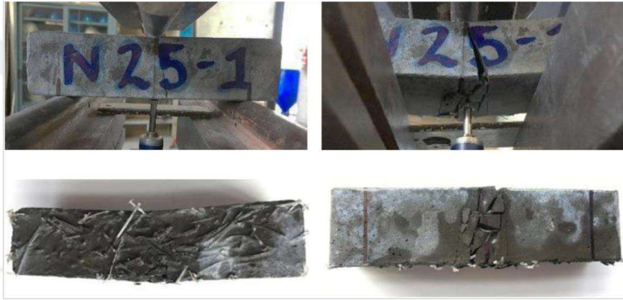
Şekil 1.5: %1.5 mikro naylon ve %0.5 makro polipropilen lif içeren UYPB kiriş numunesinin çatlak şekli (Medina vd., 2022).
