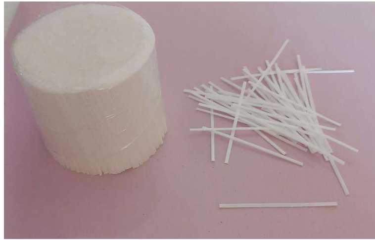
Şekil 2.2: Çalışmada kullanılan makro polipropilen lifler.
