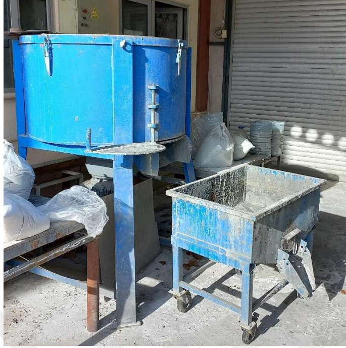
Şekil 2.3: Panmikser ve döküm aracı.
