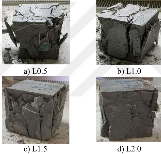
Şekil 3.1: Küp numunelerin hacimsel lif oranlarına göre kırılma şekilleri.
