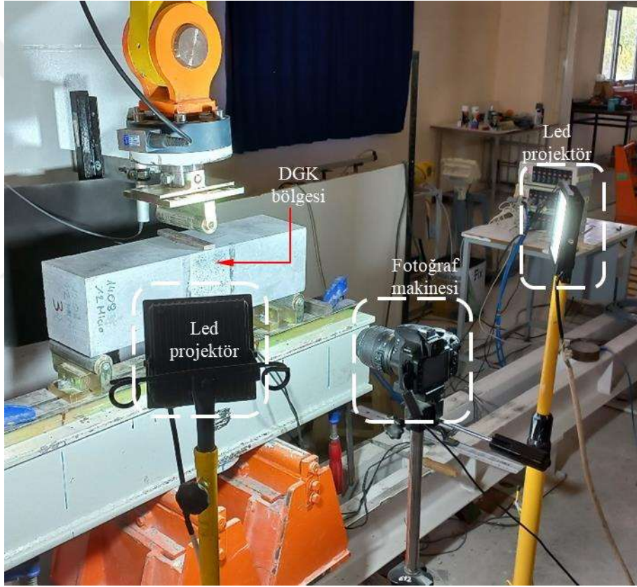
Şekil 2.13: Kamera ve ışıklandırma ile DGK test kurulumu şekli.
