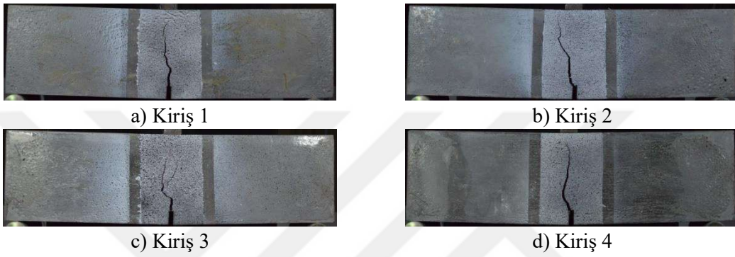
Şekil 3.10: V_f=1.0 için kirişlerin çatlak şekli.
