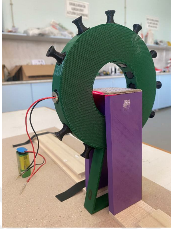
Şekil 3.36: Deney ölçüm kâğıdının yatay lazer ışını ile hizalanması.
