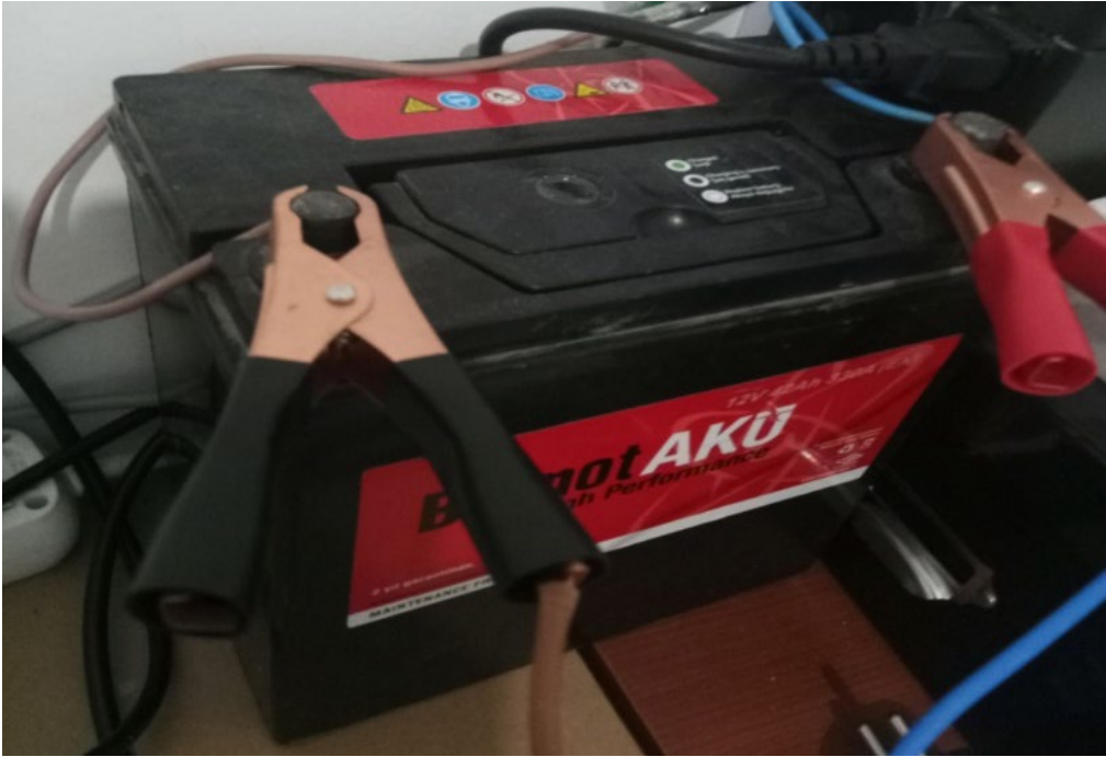
Şekil 4.7: Güç kaynağı olarak kullanılan 12V 42Ah'lik akü.
