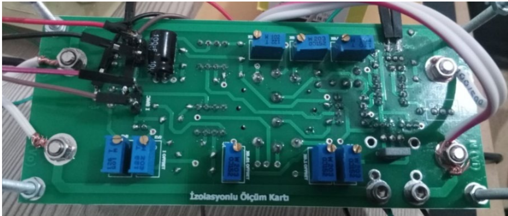
Şekil 4.18: İzolasyonlu ölçüm kartına ait tam devre resmi alt görünüşü.
