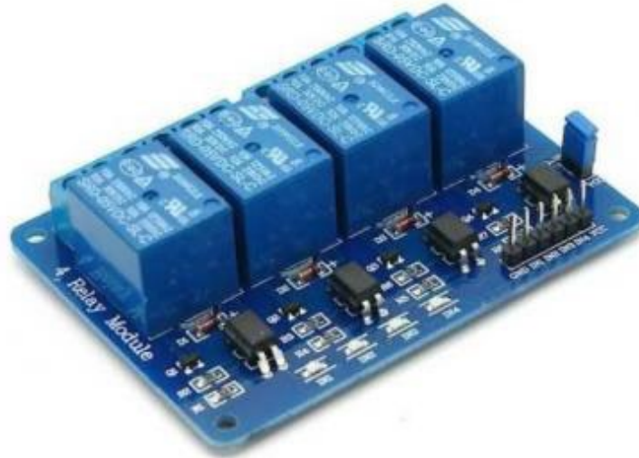
Şekil 4.50: Dörtlü 5V röle kontrol modülü.
