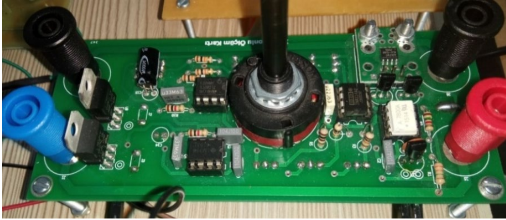
Şekil 4.17: İzolasyonlu ölçüm kartına ait tam devre resmi üst görünüşü.
