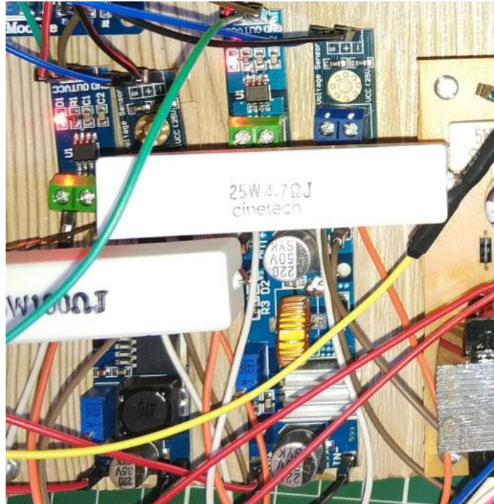
Şekil 4.40: Buck konvertör deney devresi resmi.
