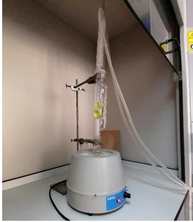
Şekil 3.8: Hazırlanan Soxhlet cihazı düzeneği.
