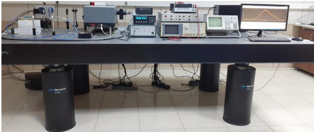
Őekil 2.2: Fotolüminesans ölçümleri için kullanılan cihaz.
