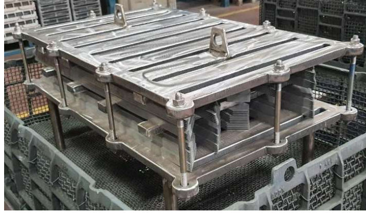
Şekil 4.19: Tavlanacak sac paketi için hazırlanmış taşıma paleti ve fırınlama öncesi genel görünüm.
