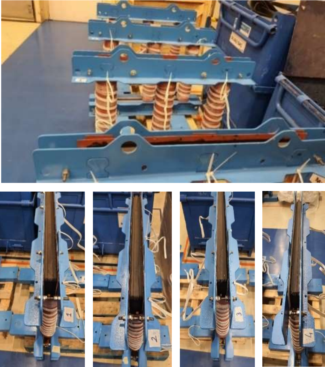
Şekil 5.20: Delikli, deliksiz, kesildiği gibi ve tavlanmış olarak üretilen prototip nüveler.
