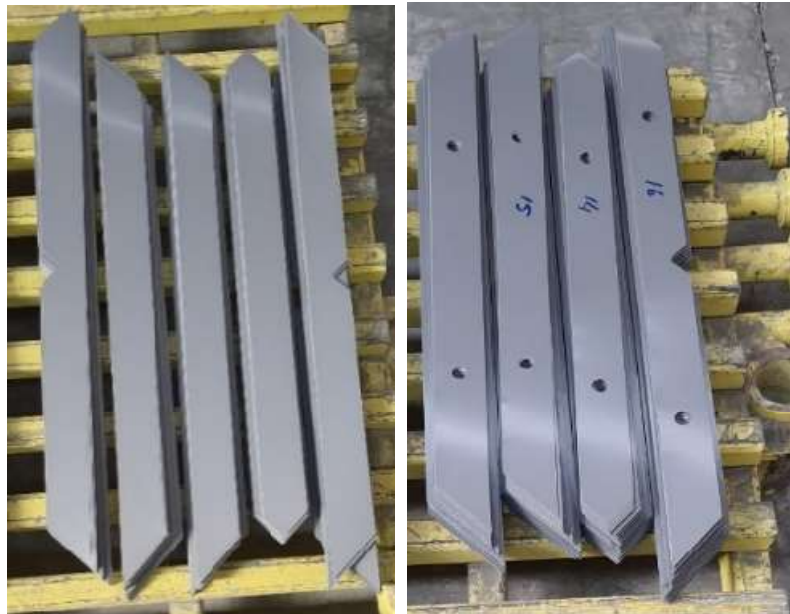
Şekil 4.18: Planlamaya uygun olarak Tip-1 M5 0,30 mm kalite sacdan delikli ve deliksiz olarak kesilen bacak ve boyunduruk sacları.
