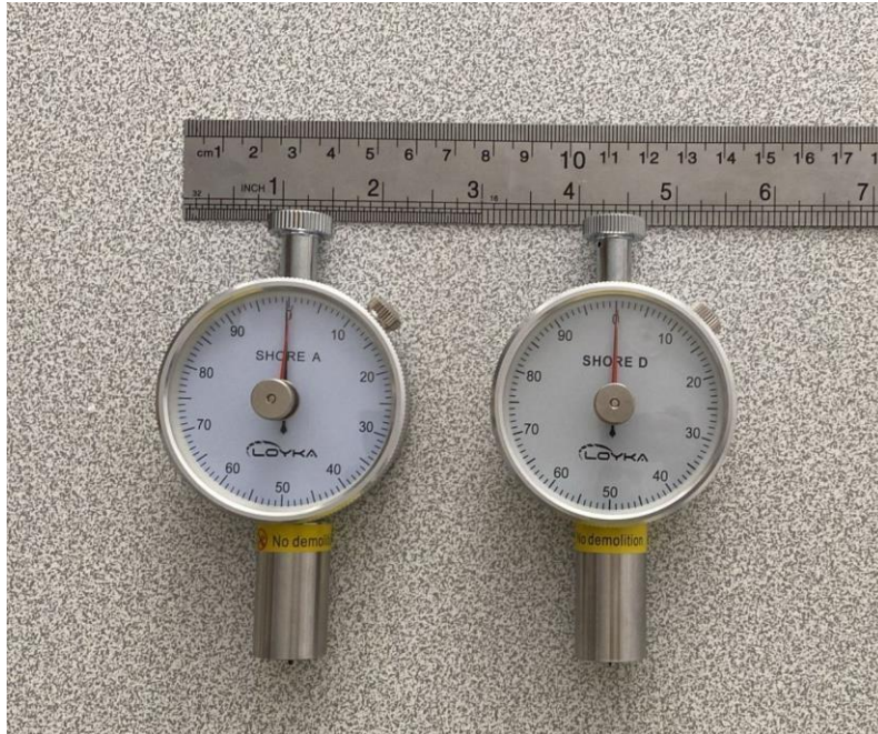
Şekil 6.20: Shore A ve Shore D modelleri.
