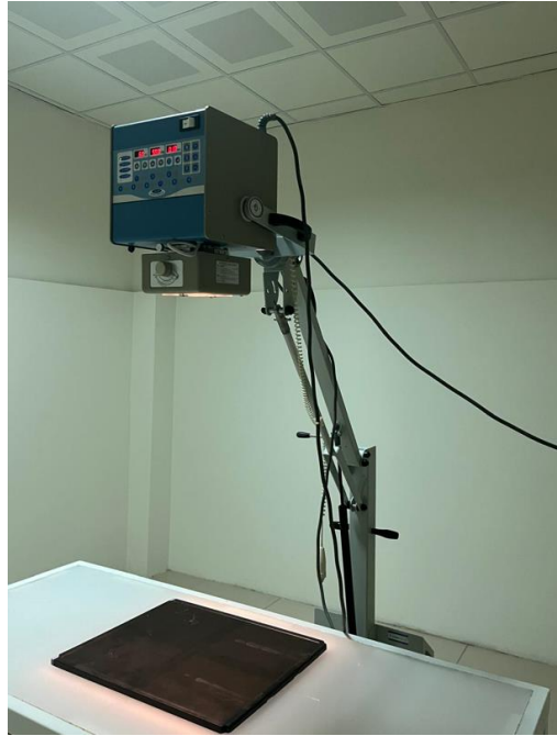
Şekil 3.1. Radyolojik muayene için kullanılan röntgen cihazı.
