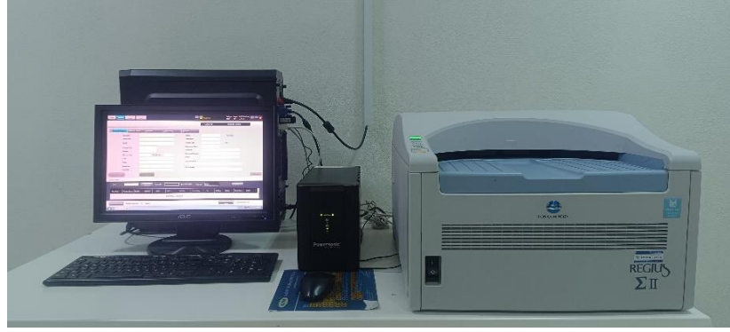
Şekil 3.2. Radyolojik muayene için kullanılan bilgisayarlı röntgen sistemi.
