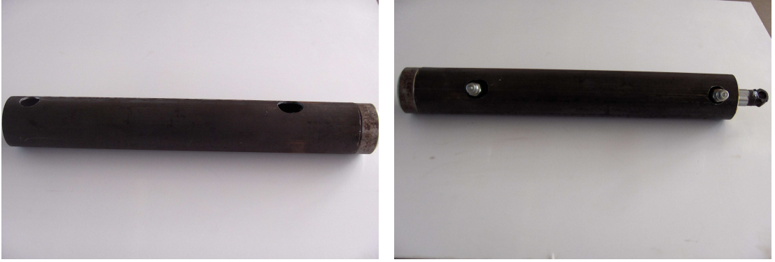
Şekil 3.2 Üretilen Hidrolik Silindir Yataklama Aparatı ve Montajı
