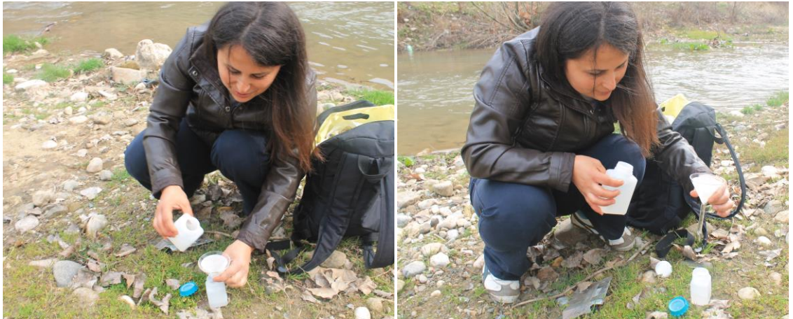
Şekil 3. İnegöl Ovası Yüzeysel Sularından Alınan Su Numunelerinin Filtre Kağıdı Yardımıyla Süzülmesi İşlemine Ait Görüntüler
