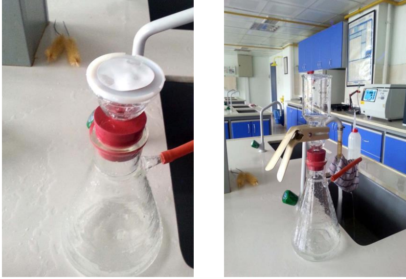
Şekil 4. İnegöl Ovası'ndan Alınan Su Numunelerinin Laboratuvar Ortamında Vakumlu Süzme Sistemi ve 0,45 mm Kalınlığındaki Filter Kağıdı Yardımıyla Süzülme İşlemine Ait Görüntüler
