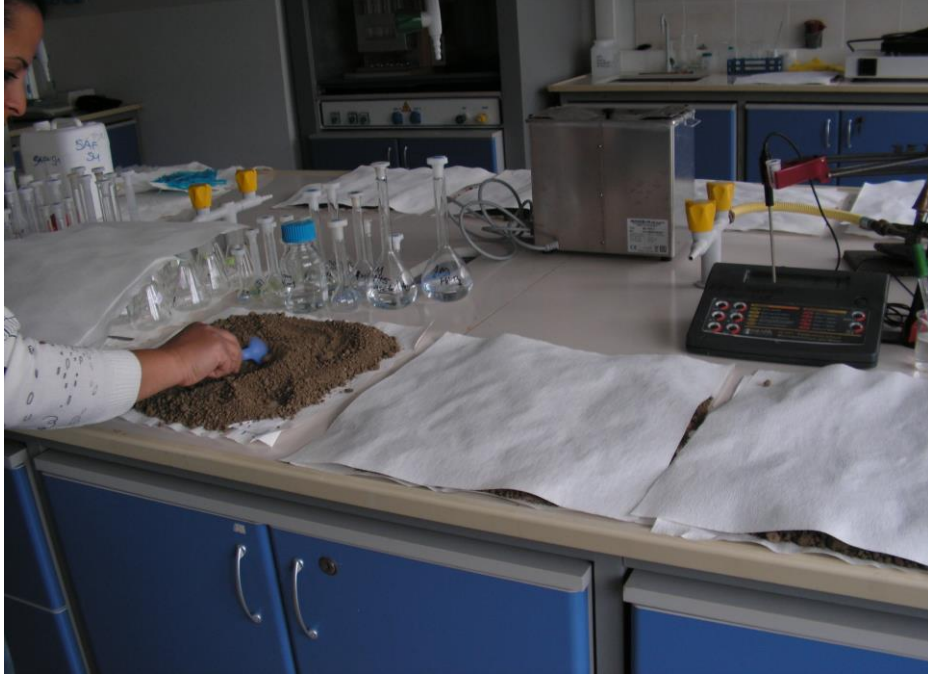
Şekil 9. Toprak Numunelerinin Geniş Süzgeç Kağıtları İçinde ve Üzeri Aynı Kağıtlarla Kapatılarak Kurutulması İşlemine Ait Görüntü
