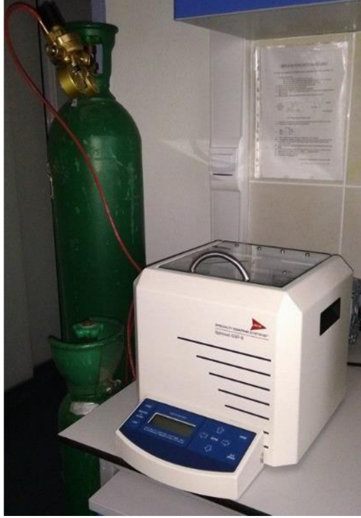
Şekil 6.3: Spin kaplama cihazı.
