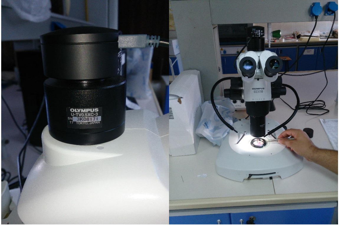
Şekil 2.5: Türlerle ait fotoğrafların çekilmesinde kullanılan Olympus U-TV0.5XC-3 marka binoküler mikroskopa bağlı Olympus Soft Imaging SC30 marka fotoğraf makinesi.
